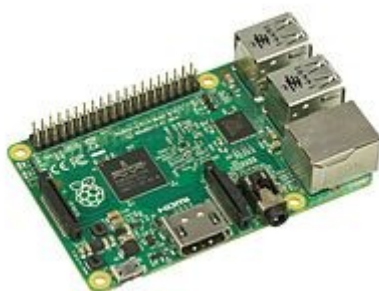
Εικόνα 2. Το Raspberry Pi 2 με επεξεργαστή 32-bit 900 MHz τεσσάρων πυρήνων ARM Cortex-A7.
