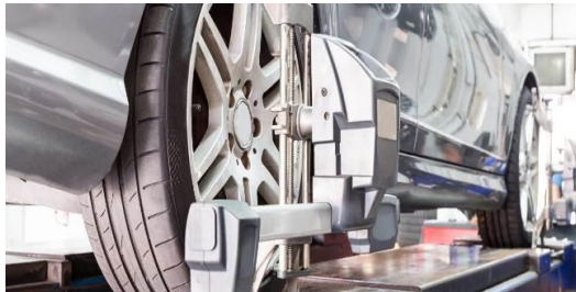
Εικόνα 4.5.1: Έλεγχος οχήματος πάνω στην πλάκα σύγκλισης-απόκλισης των τροχών του κινητήριου άξονα.
