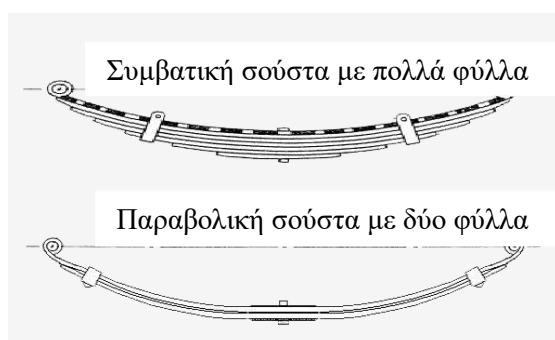
Εικόνα 3.7.1: Σύγκριση συμβατικής με παραβολική σούστα.
