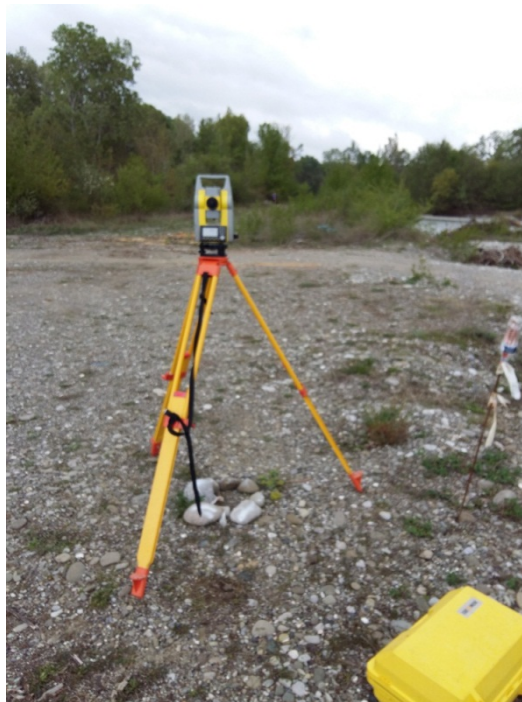
Εικόνα 6.2: Στάση της όδευσης με σήμανση, κεντρωμένο και οριζοντιωμένο το όργανο έτοιμο για διεξαγωγή μετρήσεων.
