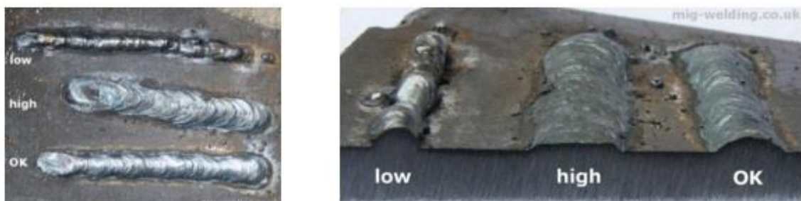
Σχήμα 32: Επίδραση της ταχύτητας προώθησης στη μορφή της συγκόλλησης
