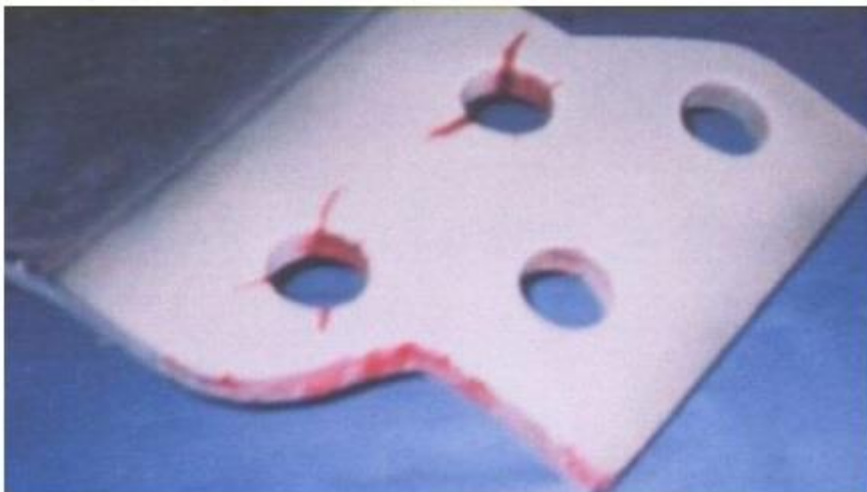
Σχήμα 65 : Έλεγχος για ρωγμές με τη βοήθεια διεισδυτικών υγρών
