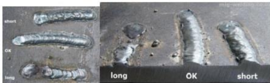
Σχήμα 31: Επίδραση του μήκους του τόξου στη μορφή της συγκόλλησης.
