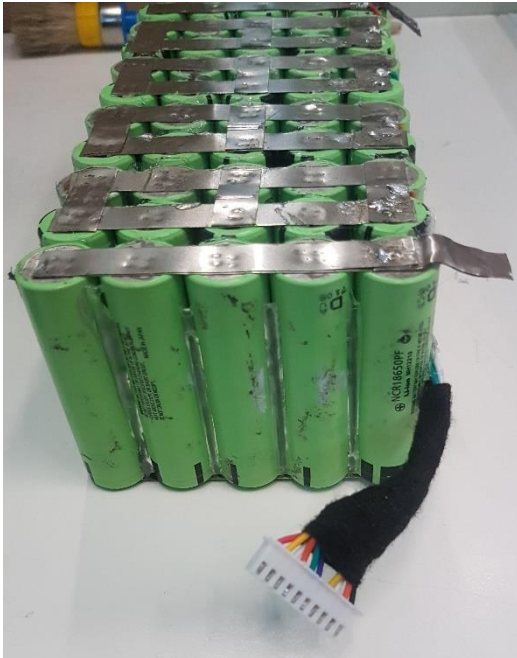
Εικόνα 4-19 Η μπαταρία ύστερα από την ψυχρή κόλληση.
