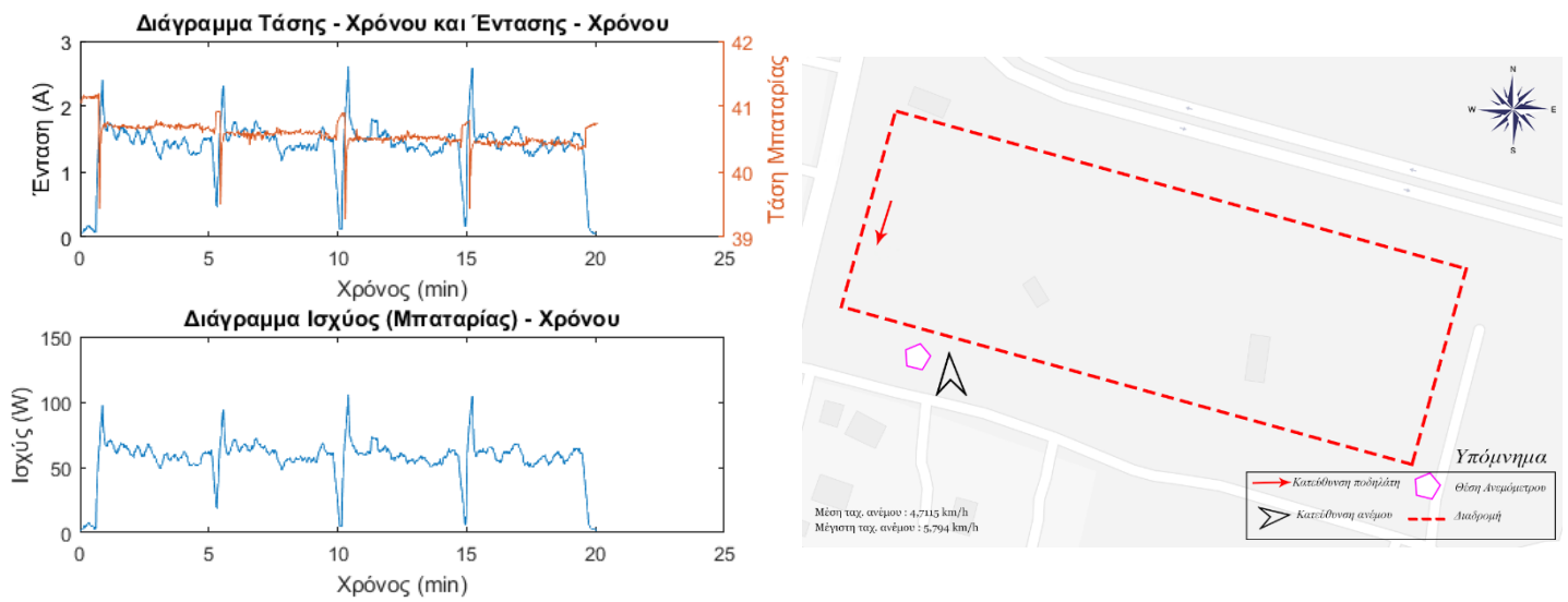
Εικόνα 6-13 Διαγράμματα Τάσης, Έντασης και Ισχύος σε σχέση με τον χρόνο και χάρτης ανέμου Δεύτερου Αναβάτη 1 ης μέτρησης.
