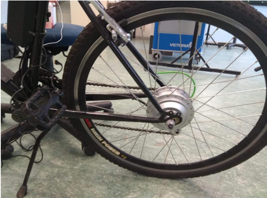
Εικόνα 4-39 Τελική τοποθέτηση τροχού με τον ηλεκτροκινητήρα.
