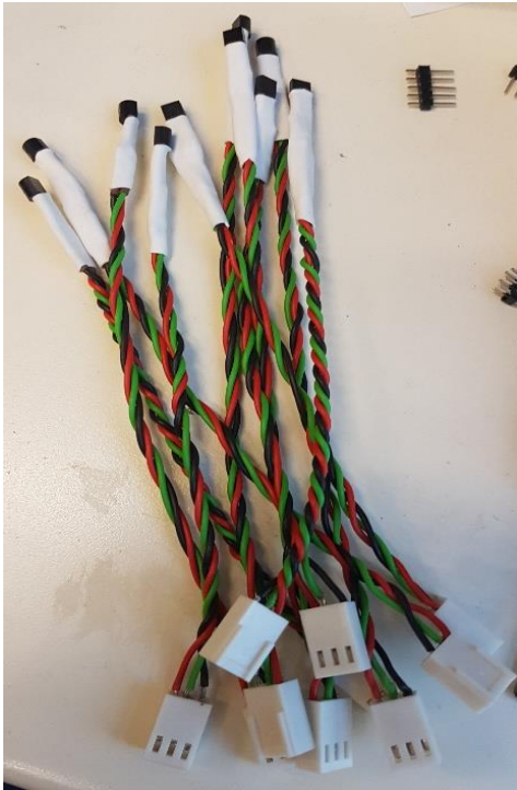
Εικόνα 6-4 Αισθητήρες θερμοκρασίας με την καλωδίωση.
