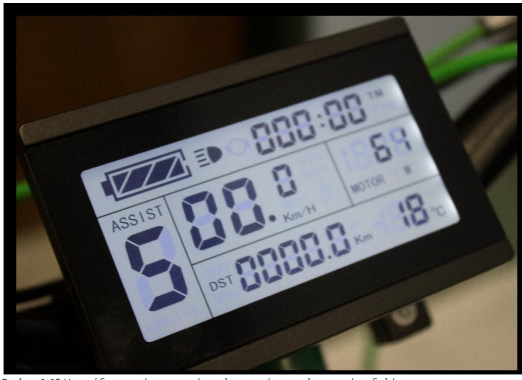
Εικόνα 4-40 Η μονάδα απεικόνισης κατά την λειτουργία του ηλεκτρικού ποδηλάτου.
