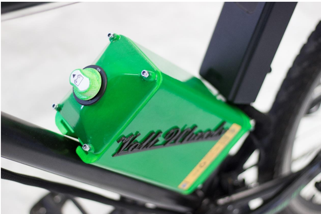
Εικόνα 4-43 Η μονάδα της μπαταρίας στην τελική της μορφή.
