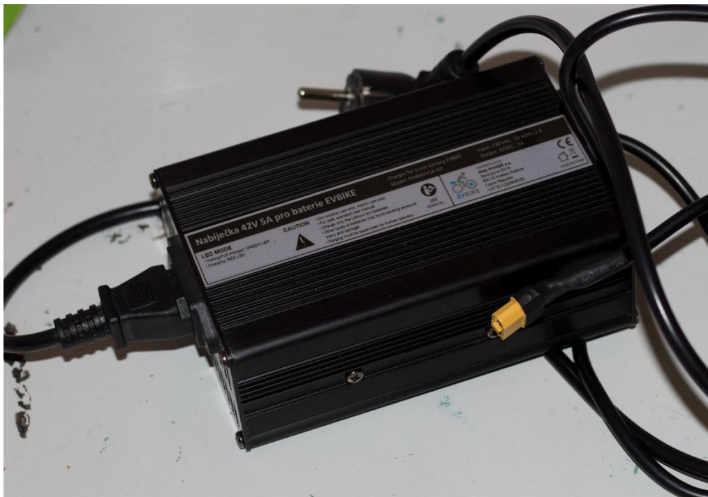
Εικόνα 4-24 Ταχυφορτιστής του ποδηλάτου 42V 5A.
