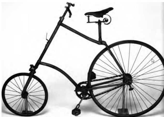
Εικόνα 2-3 Η τελική μορφή του ποδηλάτου. Το ποδήλατο ασφαλείας
