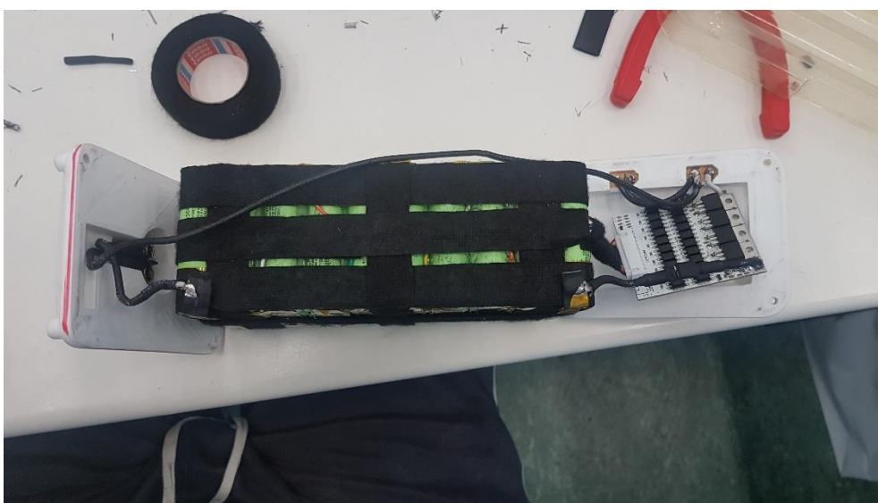
Εικόνα 4-22 Η μπαταρία με εγκαταστημένο το BMS.
