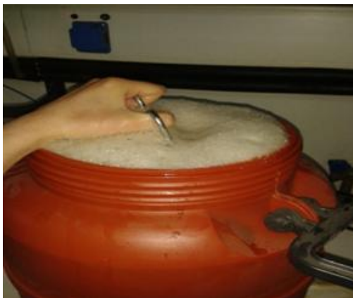
Σχήμα 8. Έκχυση αέρα στο βαρέλι μύρας για απομάκρυνση CO 2 .
