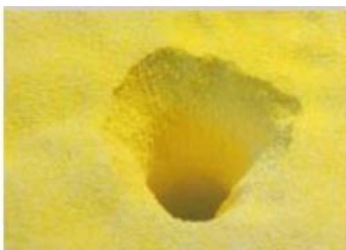
Σχήμα 6: Τρύπα λόγω κατάρρευσης της σκόνης (Prescott et al., 2000)
