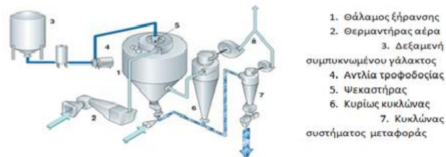
Σχήμα 4: Συμβατικός ξηραντήρας εκνέφωσης (ξήρανση ενός σταδίου) με κωνική βάση θαλάμου
