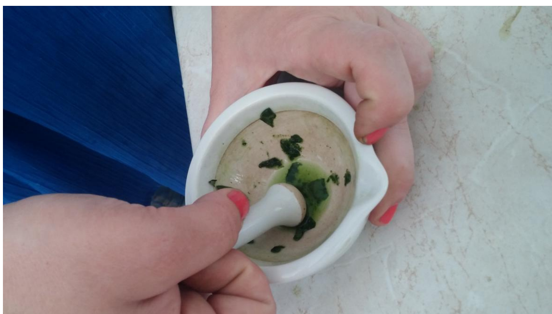
Εικόνα 21: Λειοτρίβηση φύλλων ρίγανης με καθαρή ακετόνη
