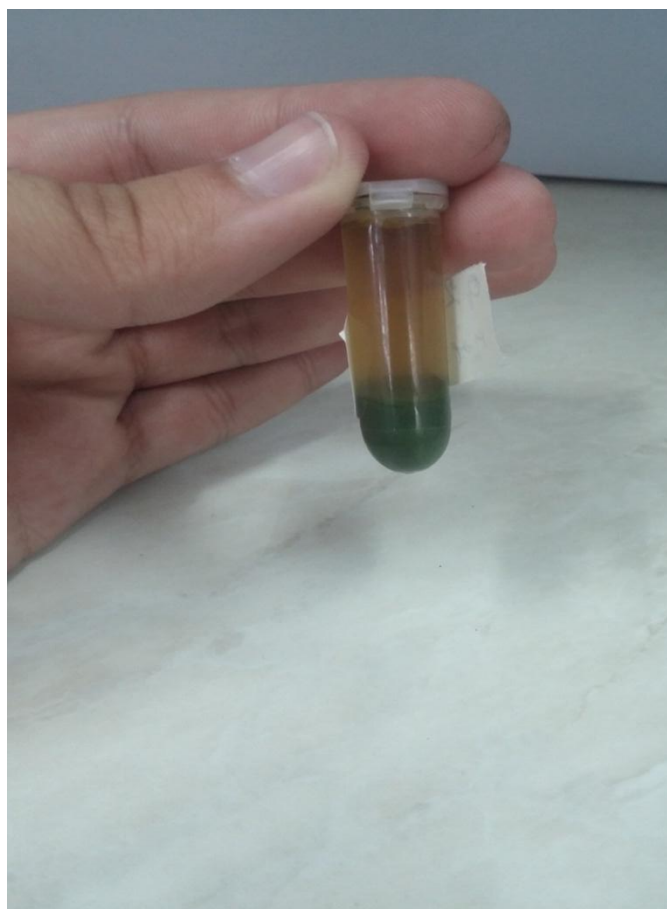
Εικόνα 22: Διαχωρισμός στερεής-υγρής φάσης αμέσως μετά την φυγοκέντρηση
