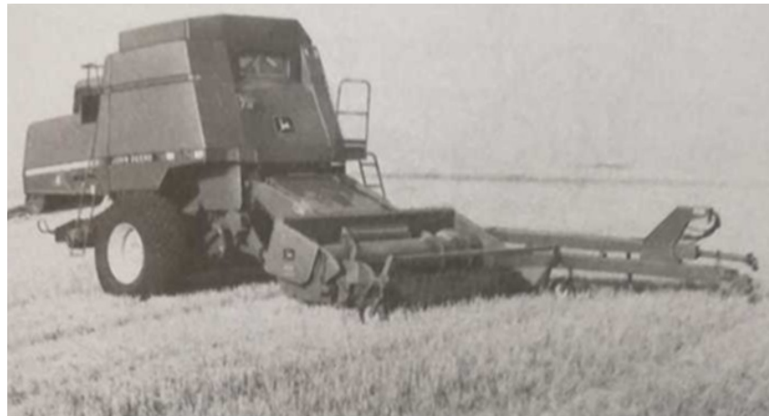
Εικόνα 3.10. Μια τυπική θεριζοαλωνιστική μηχανή που έλκεται από ελκυστήρα (Srivastava κ.α. 1993).
