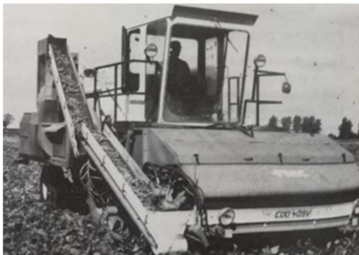
Εικόνα 4.12. Αυτοκινούμενη θεριζοαλωνιστική μηχανή πράσινων φασολιών (Culpin 2014).
