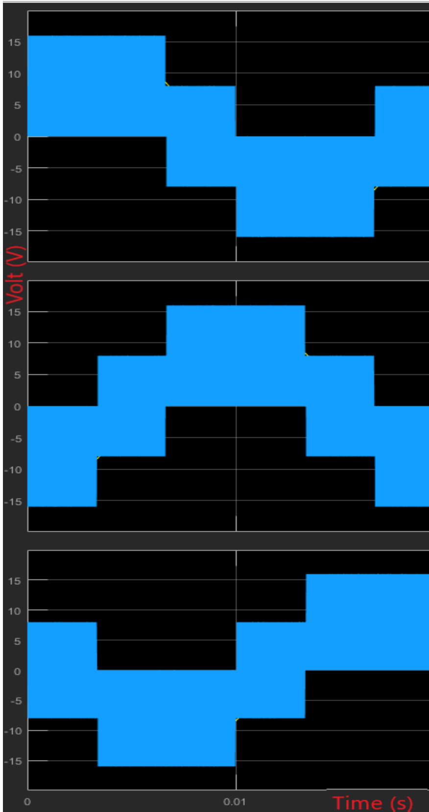
Σχήμα 2.17. Κυματομορφές των φασικών τάσεων για T_Z = 25 \mu\text{s}
