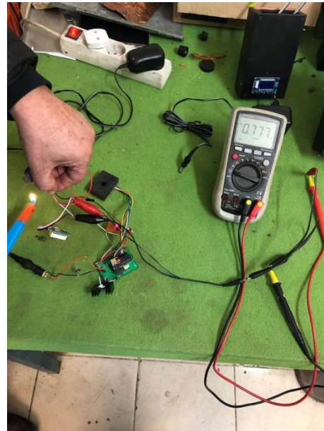
Εικόνα 50. - MQ-2 αισθητήρας με παρουσία καπνού.
