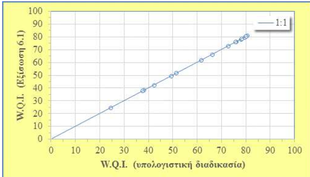
Διάγραμμα 6.19. Σύγκριση εκτίμησης του W.Q.I. με την εξίσωση (6.1) και τη συνήθη υπολογιστική διαδικασία των Meireles et al. (2010)
