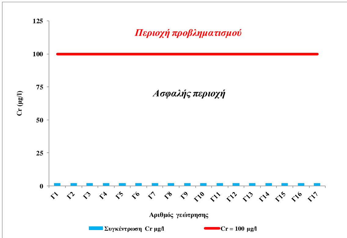
Ιστόγραμμα 6.17. Κατηγοριοποίηση του κινδύνου των συγκεντρώσεων χρωμίου (Cr) που περιέχονται στα υπόγεια νερά του Δ.Δ. Τριλόφου
