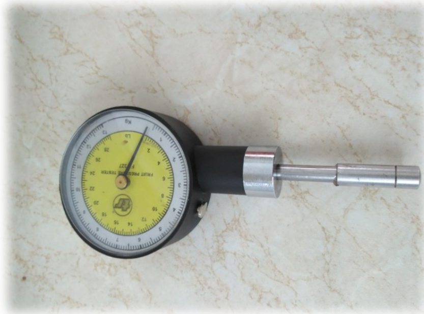
Εικόνα 54 : Πενετόμετρο , το όργανο που μετράει τη συνεκτικότητα της σάρκας της τομάτας (Πηγή: Δ.Ε.)
