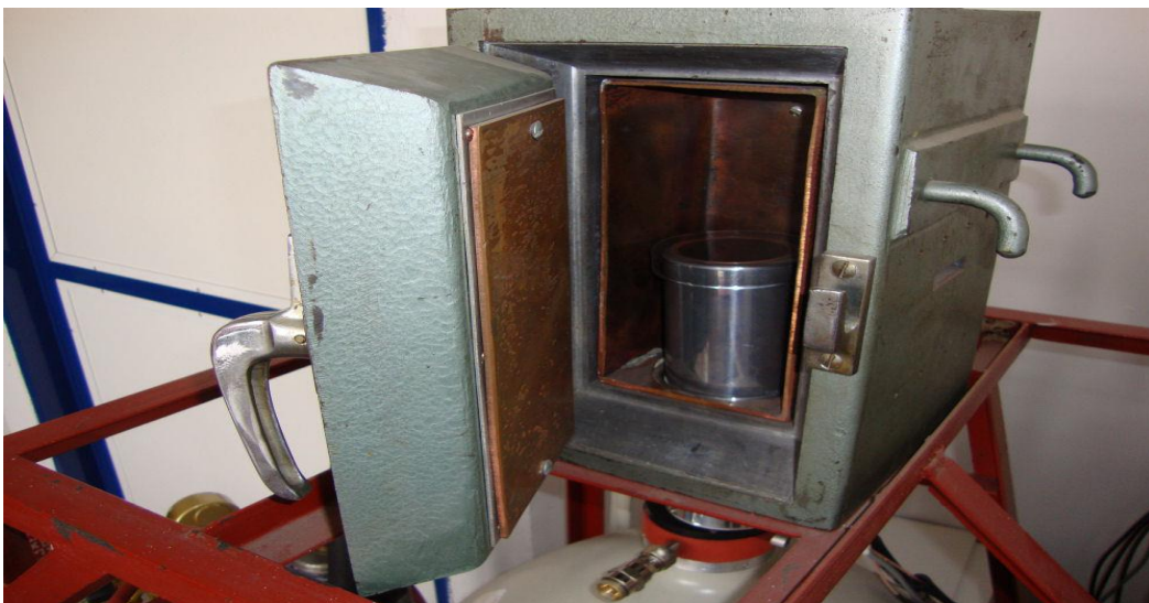
Εικόνα 2.3.3: Κρυοστάτης και θωράκιση του κρυστάλλου
