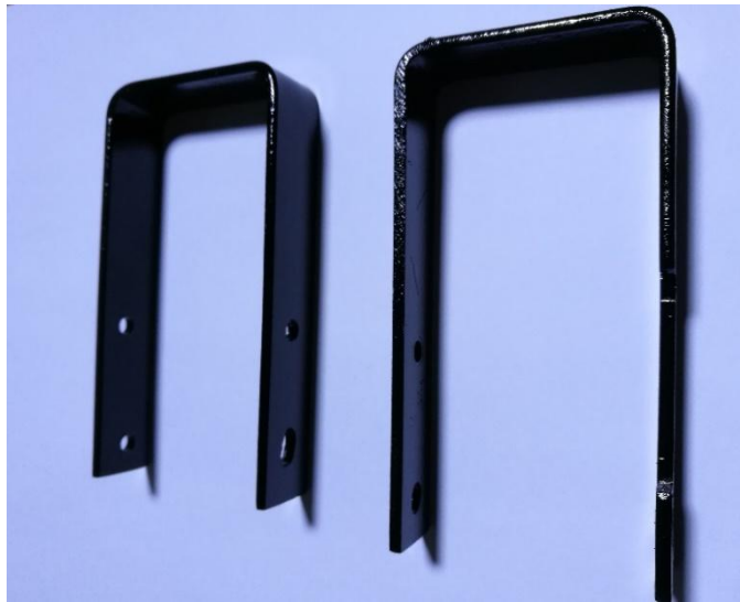
Σχήμα 42 Βάσεις στήριξης ηλεκτροκινητήρα στο πλαίσιο του τρικύκλου.
