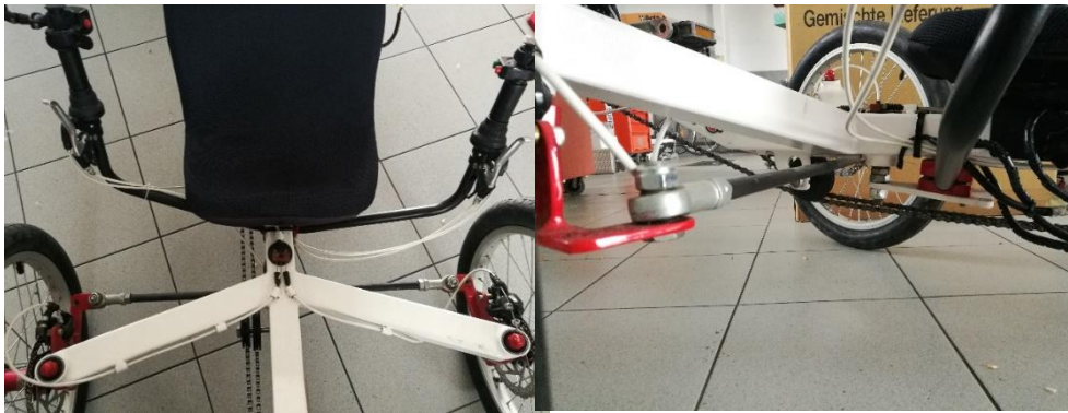
Σχήμα 21 Μηχανικό σύστημα διεύθυνσης τρίκυκλου ποδηλάτου.
