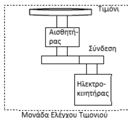
Σχήμα 4 Σύστημα steer by wire τμήμα τιμονιού. [5]
