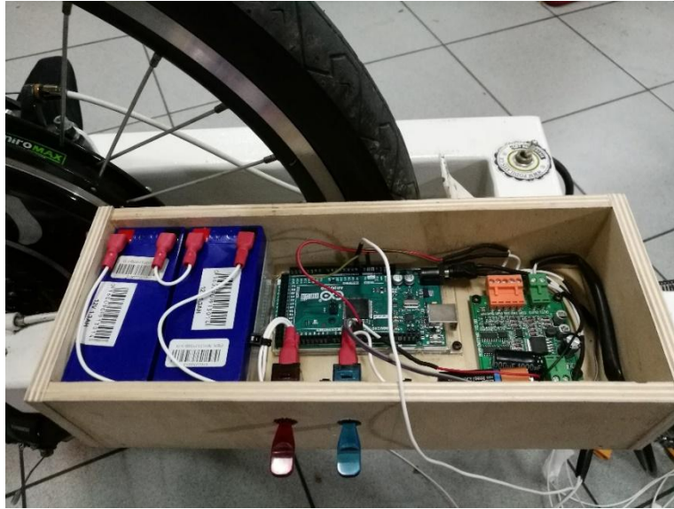
Σχήμα 47 Εύλινο πλαίσιο για την τοποθέτηση των ηλεκτρικών εξαρτημάτων.
