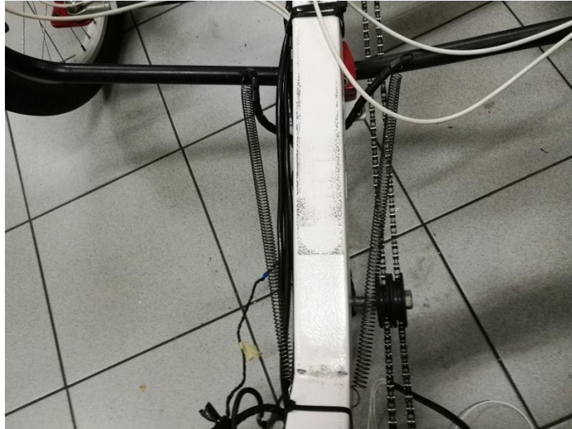
Σχήμα 48 Μηχανισμός ελατηρίων τοποθετημένα στον μηχανισμό τιμονιού.
