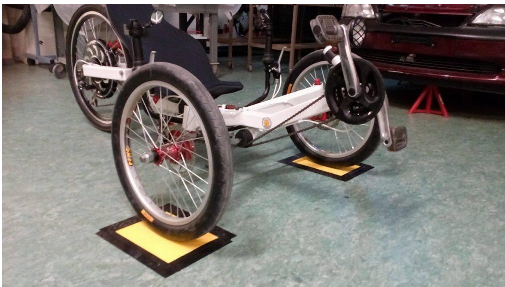
Σχήμα 22 Διεξαγωγή μετρήσεων για την ροπή σε στατική τριβή.
