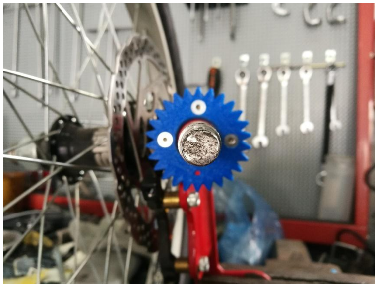
Σχήμα 41 Τοποθέτηση γραναζιού στο ακραζόνιο.
