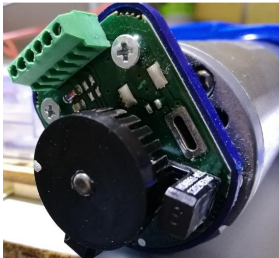
Σχήμα 30 Ο encoder τοποθετημένος στην διάταξη του ηλεκτροκινητήρα με δύο παράγωγα ζεύγη.
