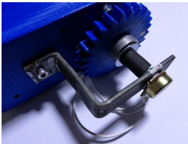
Σχήμα 45 Βάση αισθητήρα θέσης ηλεκτροκινητήρα.
