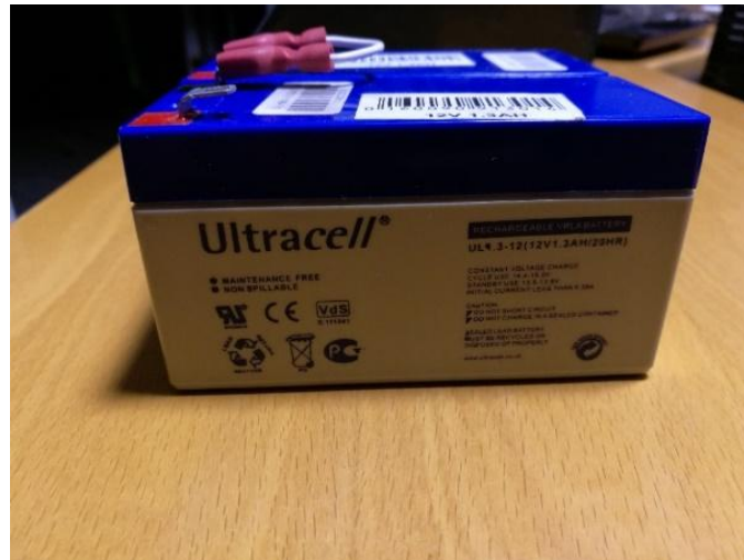
Σχήμα 35 Μπαταρίες τροφοδοσίας ηλεκτροκινητήρα οξέος – μολύβδου.
