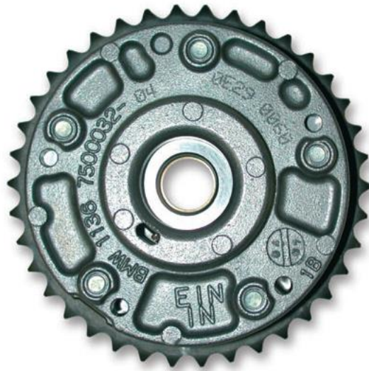
Εικόνα 38 Εξάρτημα VANOS με ευδιάκριτα αναγνωριστικά
