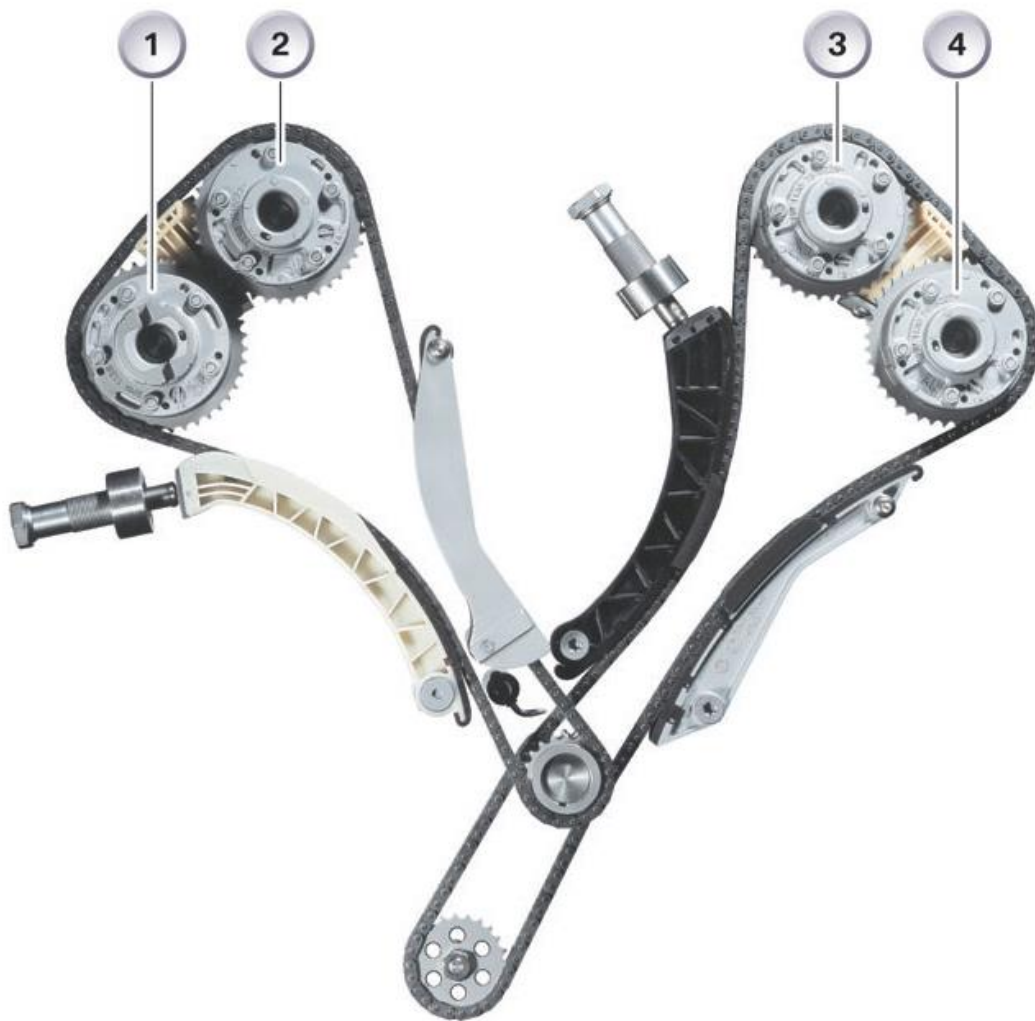
Εικόνα 44 Χρονισμός κινητήρα N73
