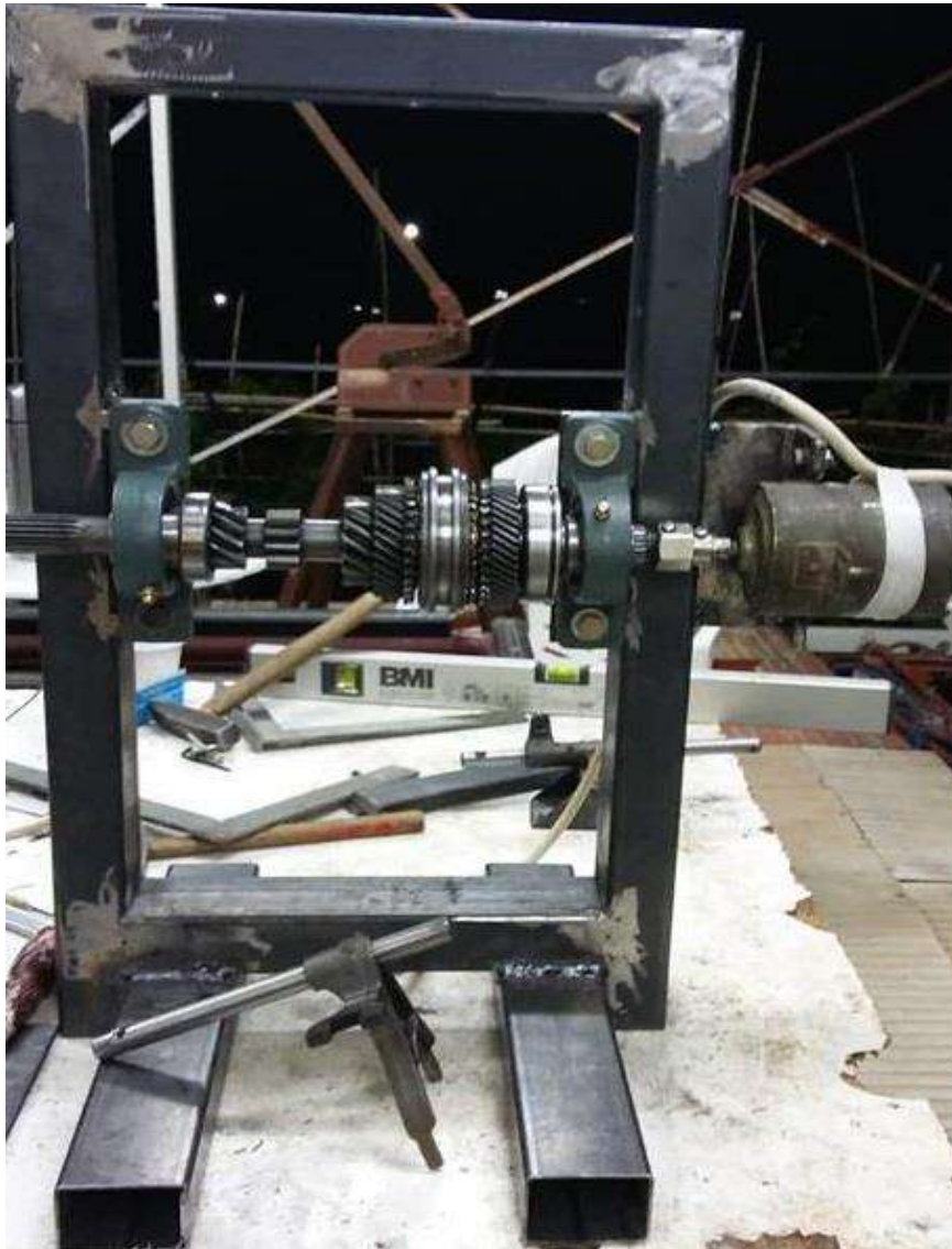
Εικόνα 82. Συναρμογή ηλεκτροκινητήρα-μετατροπέα στροφών-ροπής
