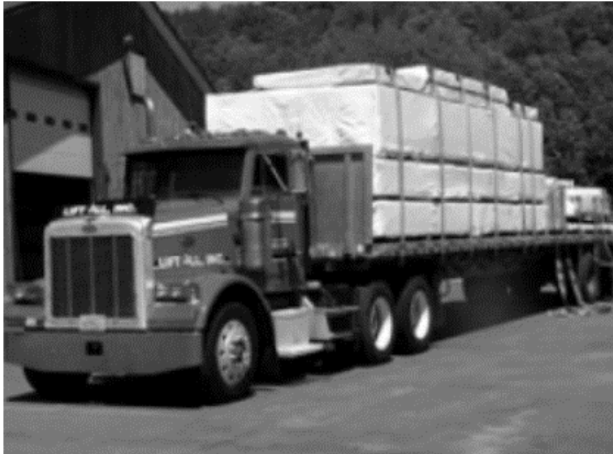
Σχήμα 2.1 Φωτογραφία κατά τη διαδικασία μεταφορά αρθρωτών δομών στον εργοτάξιο.
