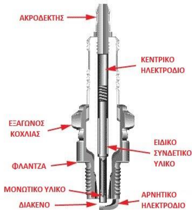
Εικόνα 2-15. Αναφλεκτήρας σε τομή
