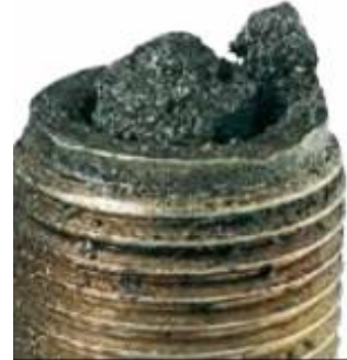
Εικόνα 2-28. Αναφλεκτήρας με μερικώς λιωμένα ηλεκτρόδια
