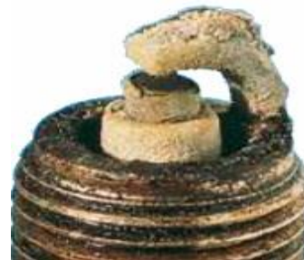
Εικόνα 2-24. Αναφλεκτήρας με υπερβολικές επικαθήσεις
