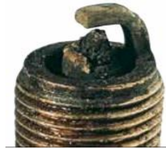
Εικόνα 2-25. Αναφλεκτήρας με λιωμένο κεντρικό ηλεκτρόδιο
