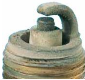
Εικόνα 2-20. Κανονική κατάσταση του αναφλεκτήρα
