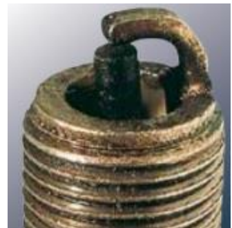
Εικόνα 2-26. Αναφλεκτήρας με σπασμένο άκρο μονωτή
