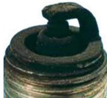
Εικόνα 2-21. Αναφλεκτήρας με συσσωρευμένες επικαθήσεις αιθάλης
