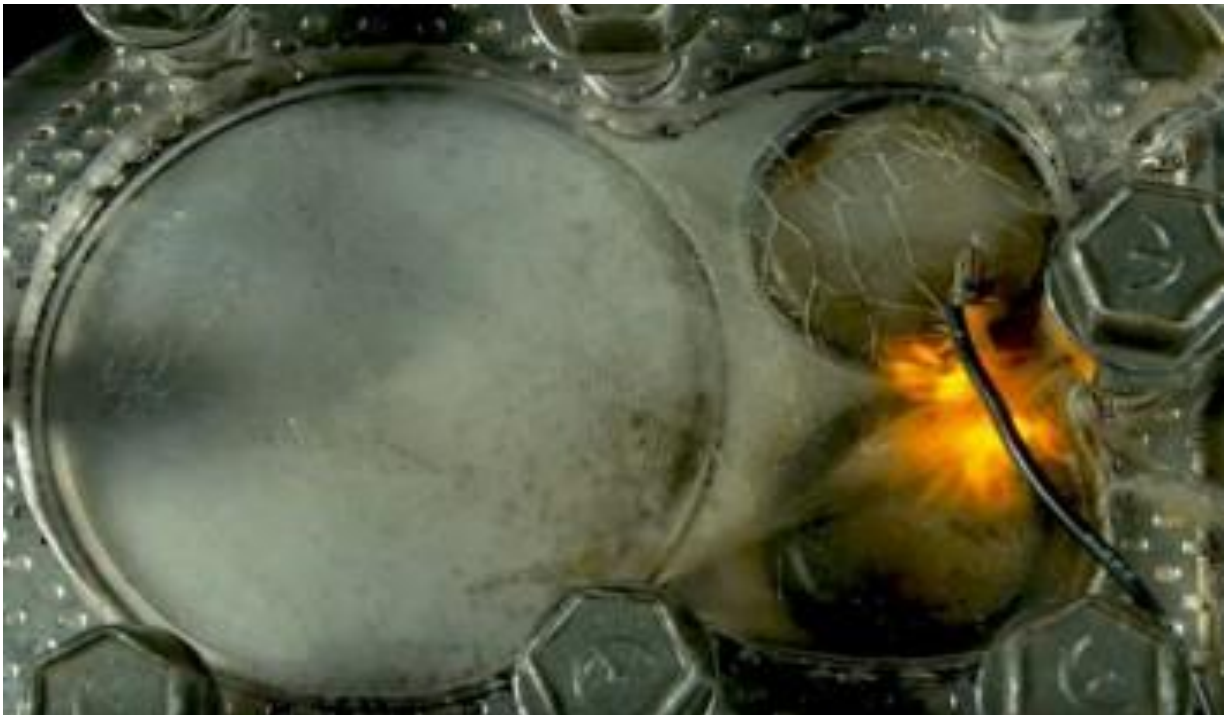
Εικόνα 2-9. Ανάφλεξη μέσα στον κύλινδρο
