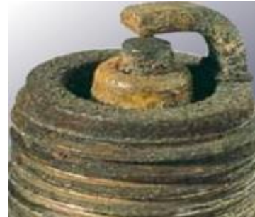
Εικόνα 2-23. Αναφλεκτήρας με σχηματισμό σμάλτου
