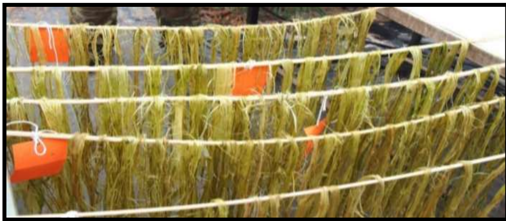
Εικόνα 17. Τοποθέτηση των ινών σε σχοινιά για να στεγνώσουν.
