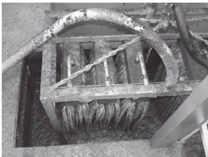
Σχήμα 2.9. Έμφραξη της συγκεκριμένης μεμβράνης κοίλων ινών έχει οδηγήσει σε βούλωμα (clogging) (Park et al., 2015).
