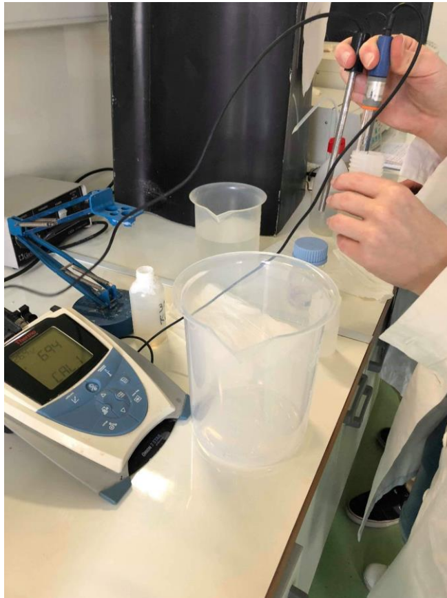
Σχήμα 15: Καλιμπράρισμα πεχαμέτρου και μέτρηση pH δείγματος.
