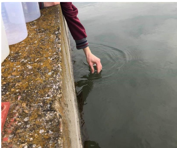
Σχήμα 16: Δειγματοληψία νερού σε φιάλες BOD για ανάλυση του διαλυμένου οξυγόνου.
