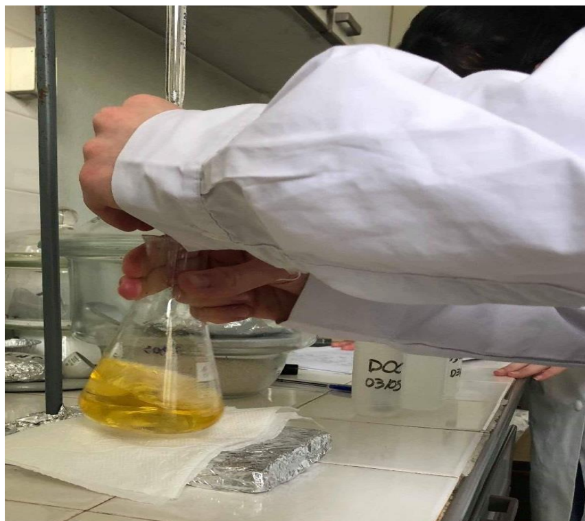
Σχήμα 19: Τιτλοδότηση του ιωδίου με πρότυπο διάλυμα \text{Na}_2\text{S}_2\text{O}_3 .
