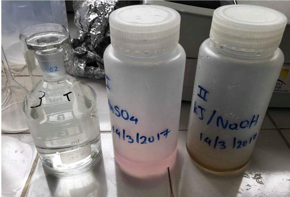
Σχήμα 17: Από αριστερά προς τα δεξιά: φιάλη BOD, διάλυμα MnSO_4 και διάλυμα KI/NaOH .
