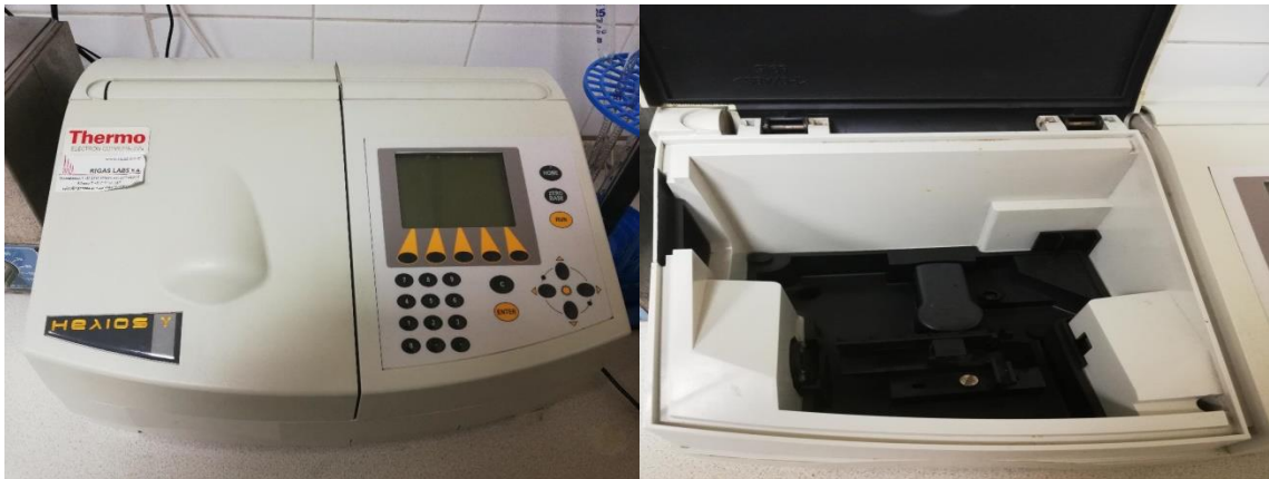
Σχήμα 30: Φασματοφωτόμετρο απλής δέσμης (αριστερά) και το εσωτερικό τμήμα αυτού (δεξιά).
