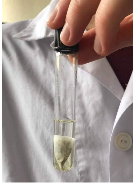
Σχήμα 23: Φίλτρο 0,45 µm με οργανικό περιεχόμενο σε διάλυμα ακετόνης 90%.
