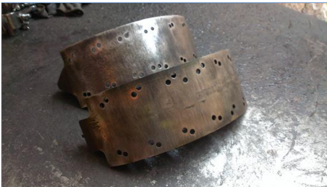
Εικόνα 18:Θερμούιτ (σιαγόνες) ταμπύρου φορτηγού(2)
