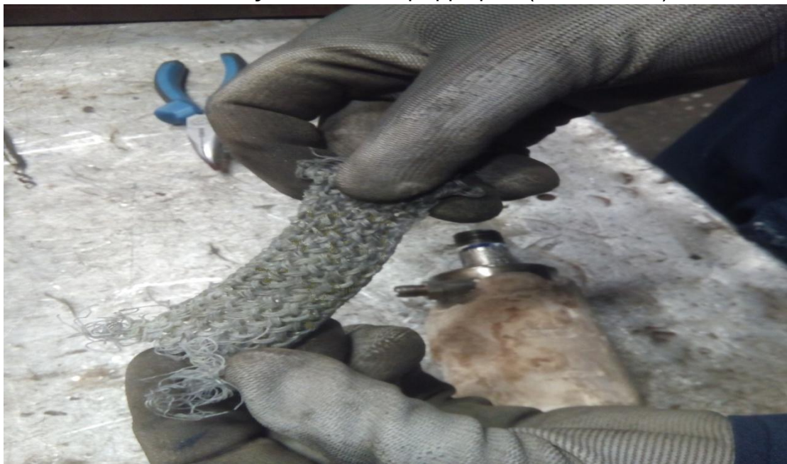
Εικόνα 2.3.6 Φθαρμένο και λερωμένο από θειάφι φίλτρο.
