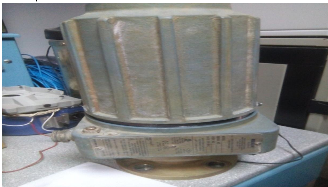
Εικόνα 1.1.1 Κύριο Σώμα του αναλυτή οξυγόνου OCX 8800
