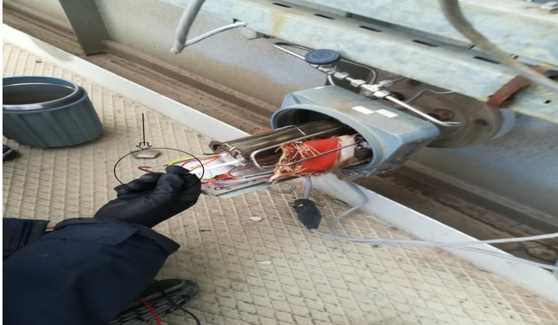
Εικόνα 1.3.8 Αναλυτής οξυγόνου δίπλα από τον φούρνο του διυλιστηρίου, στον οποίο βρέθηκαν καμένα καλώδια.
