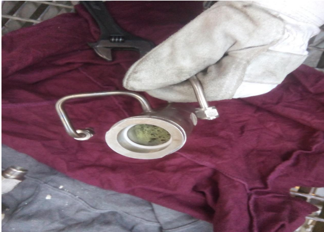
Εικόνα 2.3.4 Το Cell- κέλυφος είναι το σημείο από το οποίο εκπέμπετε το φως του αναλυτή για να δείξει αποτελέσματα, όπου είναι εμφανώς λερωμένο.
