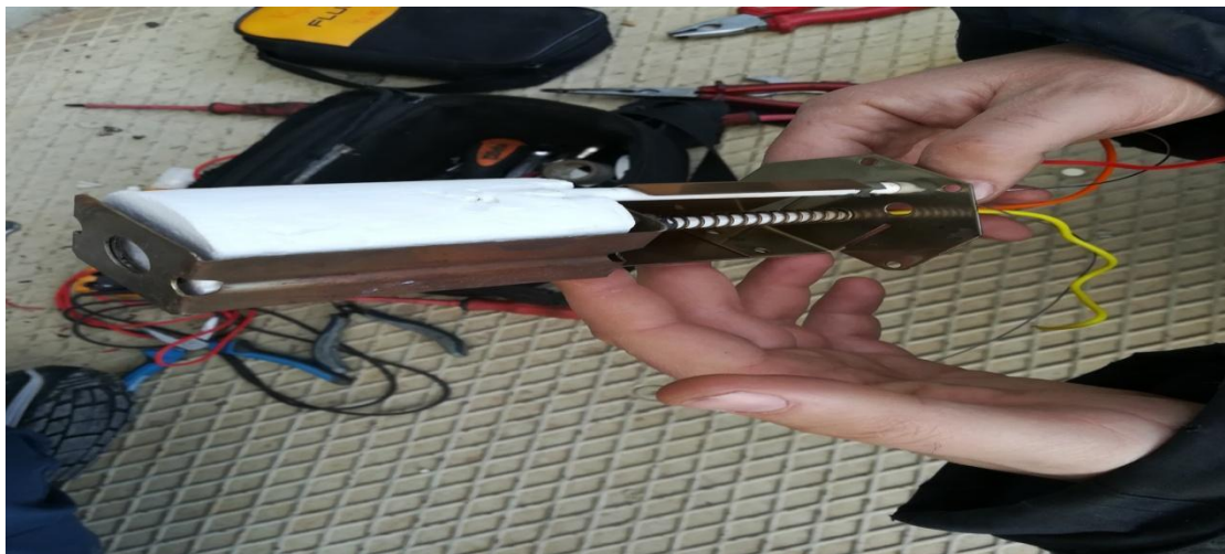
Εικόνα 1.3.9 Έλεγχος του αισθητήρα για πιθανά κατεστραμμένα καλώδια ή αντικείμενα για την σωστή του λειτουργία, με σκοπό την αντικατάστασή τους.
