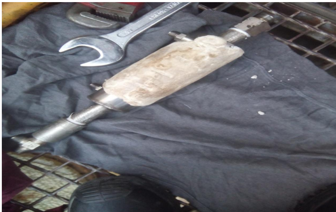
Εικόνα 2.3.3 Το Demister όπου γίνεται η συμπύκνωση των υγροποιήσεων/ατμών του θειαφίου
