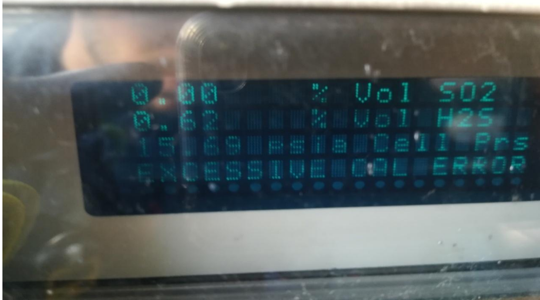
Εικόνα 2.3.1 Ένδειξη αναλυτή υδρόθειου , παρατηρείται ότι για διοξείδιο του άνθρακα η μέτρηση είναι μηδενική το οποίο προκαλεί πρόβλημα στην λειτουργία του αναλυτή.
