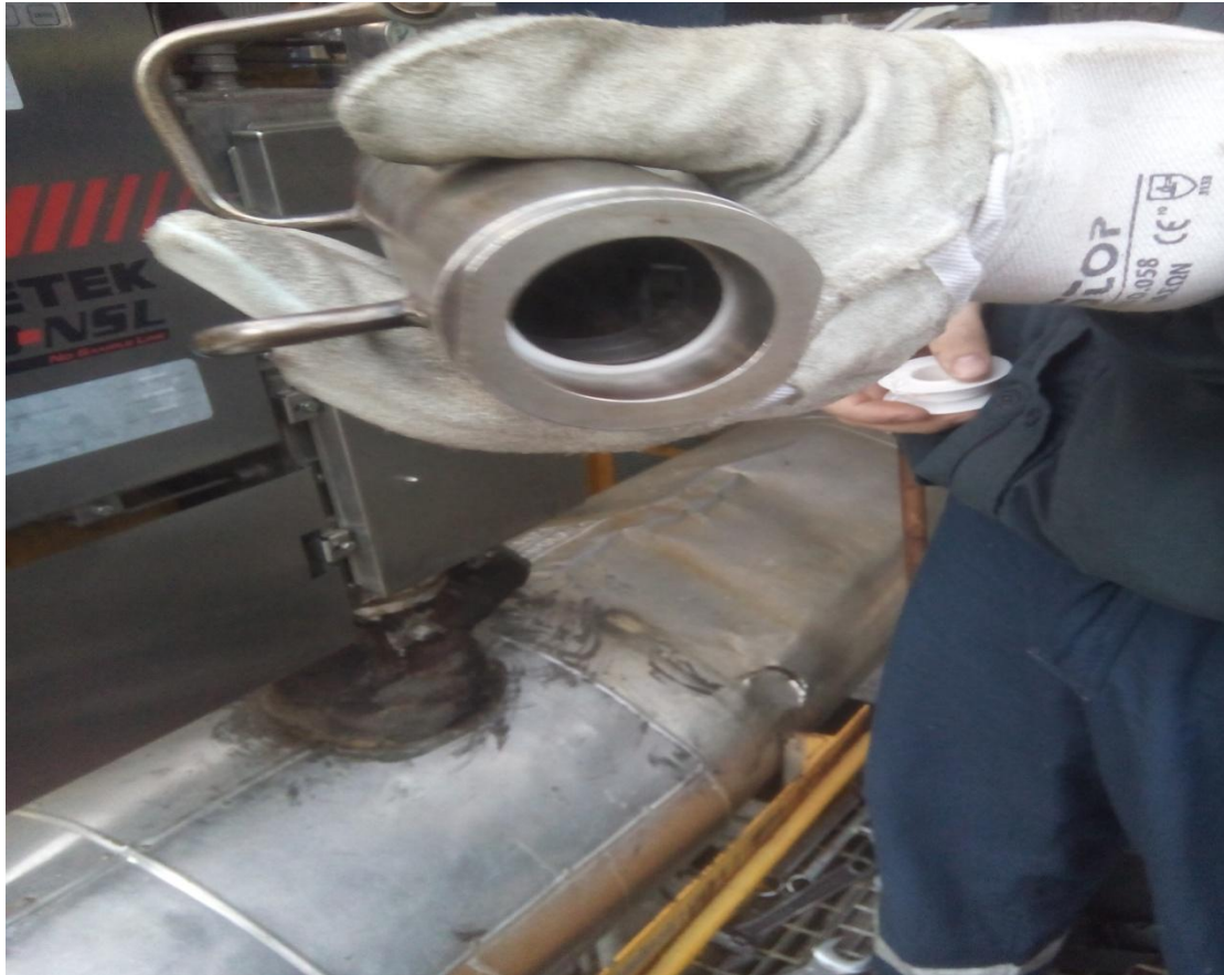
Εικόνα 2.3.8 Το κέλυφος – Cell καθαρό και έτοιμο για την επανατοποθέτηση του.
