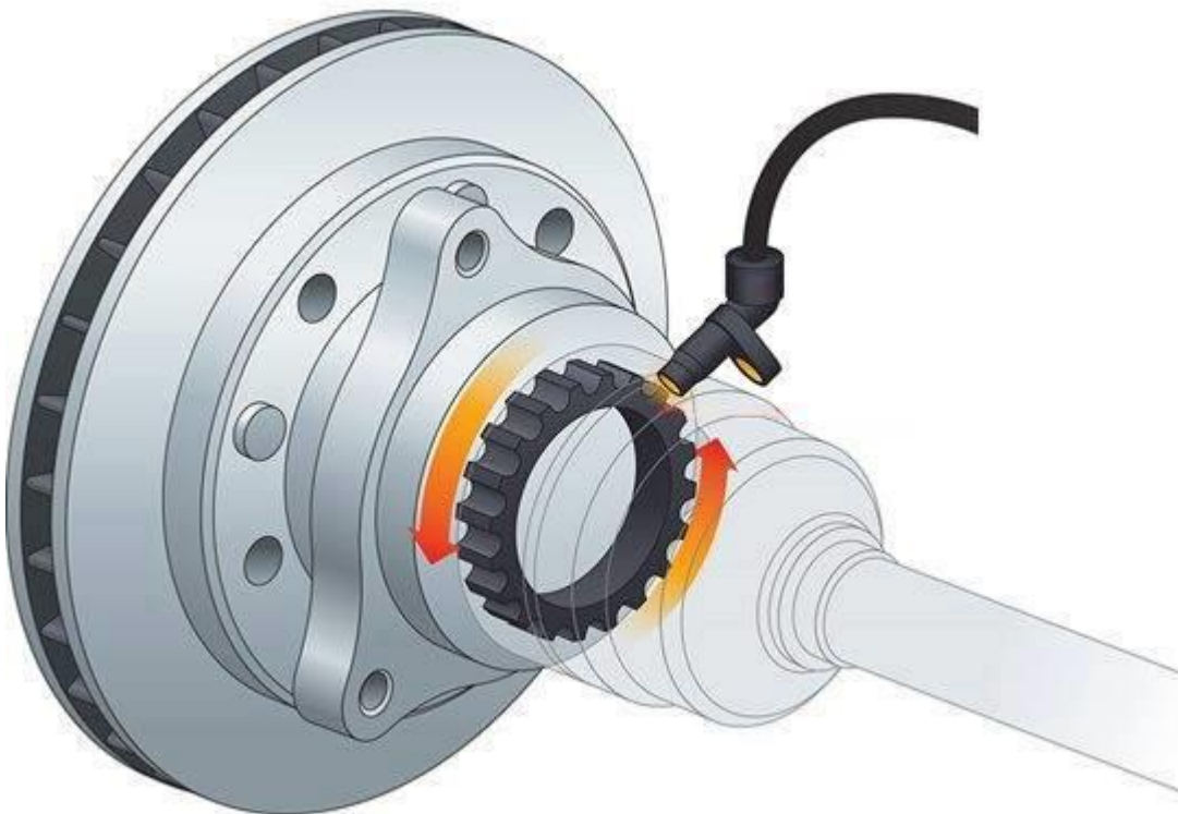
Εικόνα 16. Τυπική διάταξη συστήματος καταμέτρησης στροφών του τροχού
