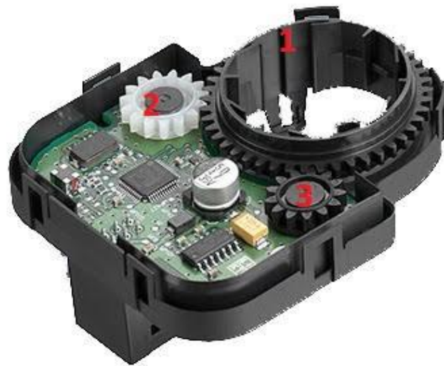
Εικόνα 32 Τομή SAS μαγνητοαντίστασης
