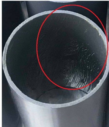
Εικόνα 5.2.3. Μήτρες δοκιμίων με την επάλειψη τους με γράσσο
