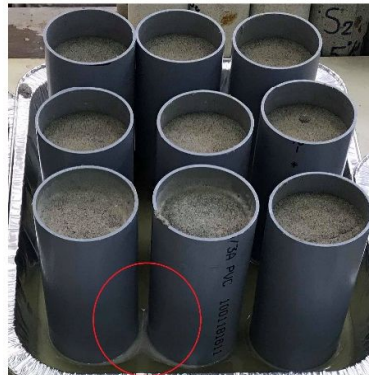
Εικόνα 5.2.7. Λιμνάζων νερό στην επιφάνεια των δοκιμίων αλλά και την επιφάνεια τοποθέτησης τους, αμέσως μετά την ρίψη του μείγματος.
