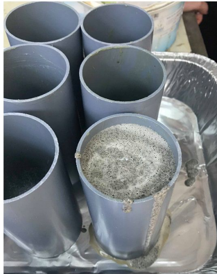
Εικόνα 5.2.8. Φαινόμενο διαρροής υγρού κατά την διάρκεια σκλήρυνσης του μείγματος.
