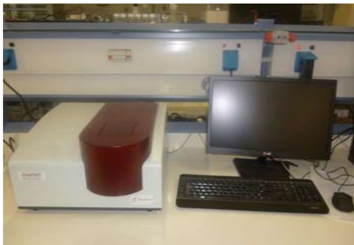
Εικόνα 4: Brookhaven ZetaPALS της Brookhaven Instruments Corporation, Brookhaven, Holtsville, για τη μέτρηση του ζ-δυναμικού (Ερευνητικό Εργαστήριο του Τμήματος Τεχνολογίας Τροφίμων του Α.Τ.Ε.Ι.Θ)
