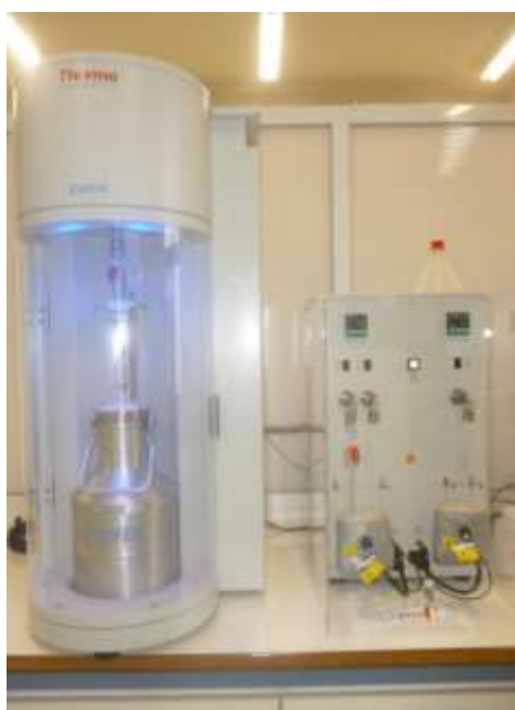
Εικόνα 3: Ποροσίμετρο Surfer Thermo Scientific (Ερευνητικό Εργαστήριο του Τμήματος Τεχνολογίας Τροφίμων του Α.Τ.Ε.Ι.Θ)
