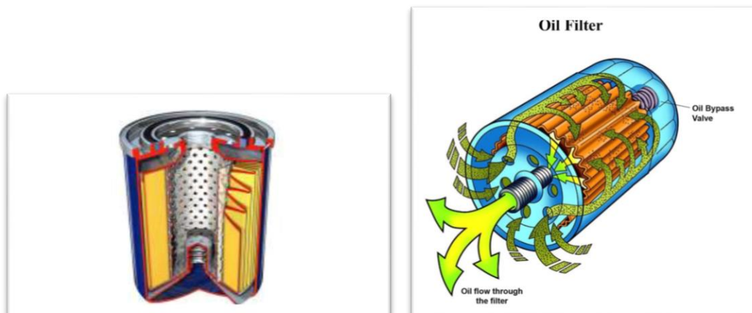
Εικόνα 2.10 Ανταλλάξιμα φίλτρα σε τομή
