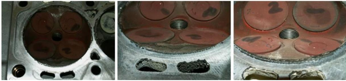
Εικόνα 4.20 Η κόκκινη σκόνη είναι ένα προϊόν φθοράς του μετάλλου, και ανθρακωμάτων. Αυτή η κόκκινη σκόνη ενεργεί σαν «άμμος» και θα φθείρει τις βαλβίδες και τις έδρες των βαλβίδων. Αυτό προκαλεί ραγδαία αύξηση της φθοράς στις βαλβίδες εξαγωγής των κυλίνδρων Νο1 και Νο 4. Η φθορά των βαλβίδων είναι συνεχώς αυξανόμενη.
