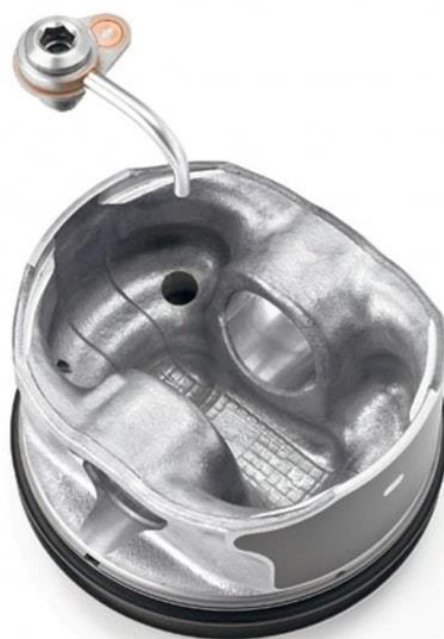
Εικόνα 4.9 Το λάδι σε ρόλο ψυκτικού υγρού : κάτω μέρος εμβόλου μαζί με το μπεκ ψεκασμού λαδιού
