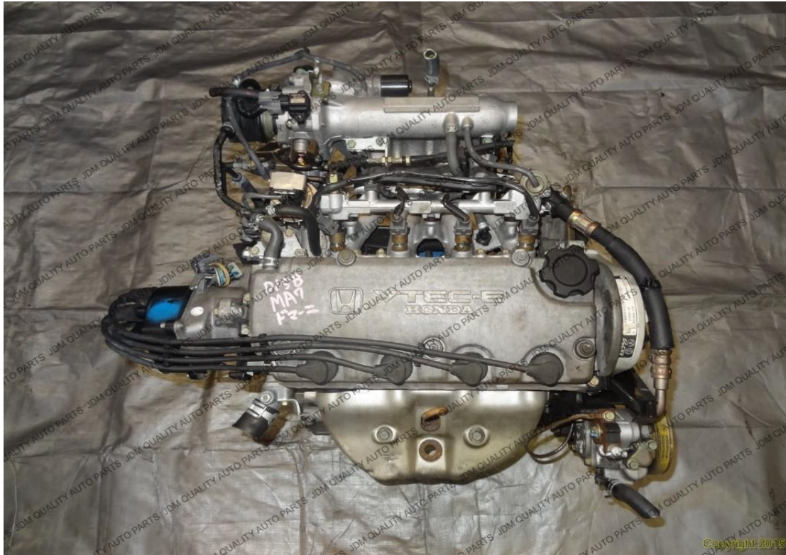
Εικόνα 6.3.α : Κινητήρας D15B HONDA SOHC με σύστημα VTEC – E παραγωγής 1992-1995 (Πηγή: http://www.jdmquality.com/honda-acura/d15b-sohc-vtec-e-engine-automatic-transmission-92-95.html ).
