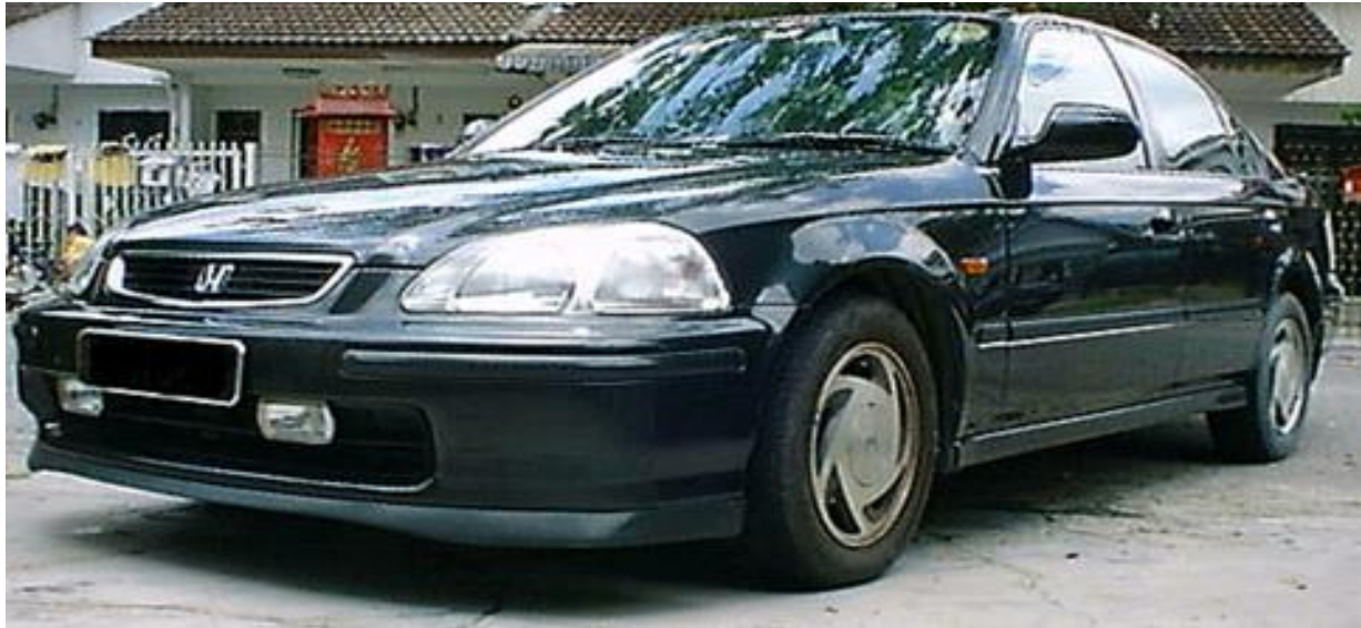
Εικόνα 6.2 δ : HONDA Civic JDM. Γνωστό σαν Civic Ferio Si Doch D15B με τρία στάδια VTEC και 130 ίππους (Πηγή: http://asia.vtec.net/article/EK3Vi/ ).
