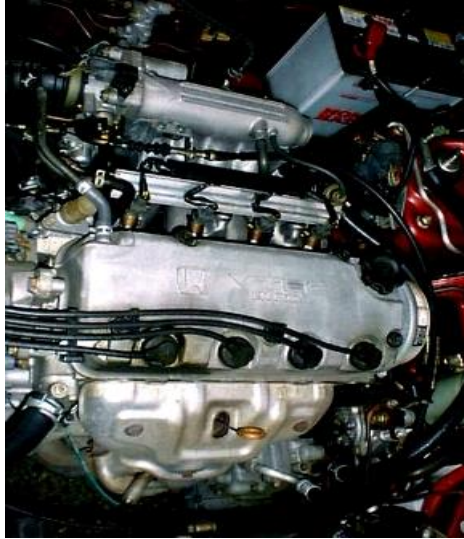
Εικόνα 6.4.3 α : Κινητήρας D15B με εφαρμογή 3 σταδίων VTEC (Πηγή: http://asia.vtec.net/article/d15b/ ).
