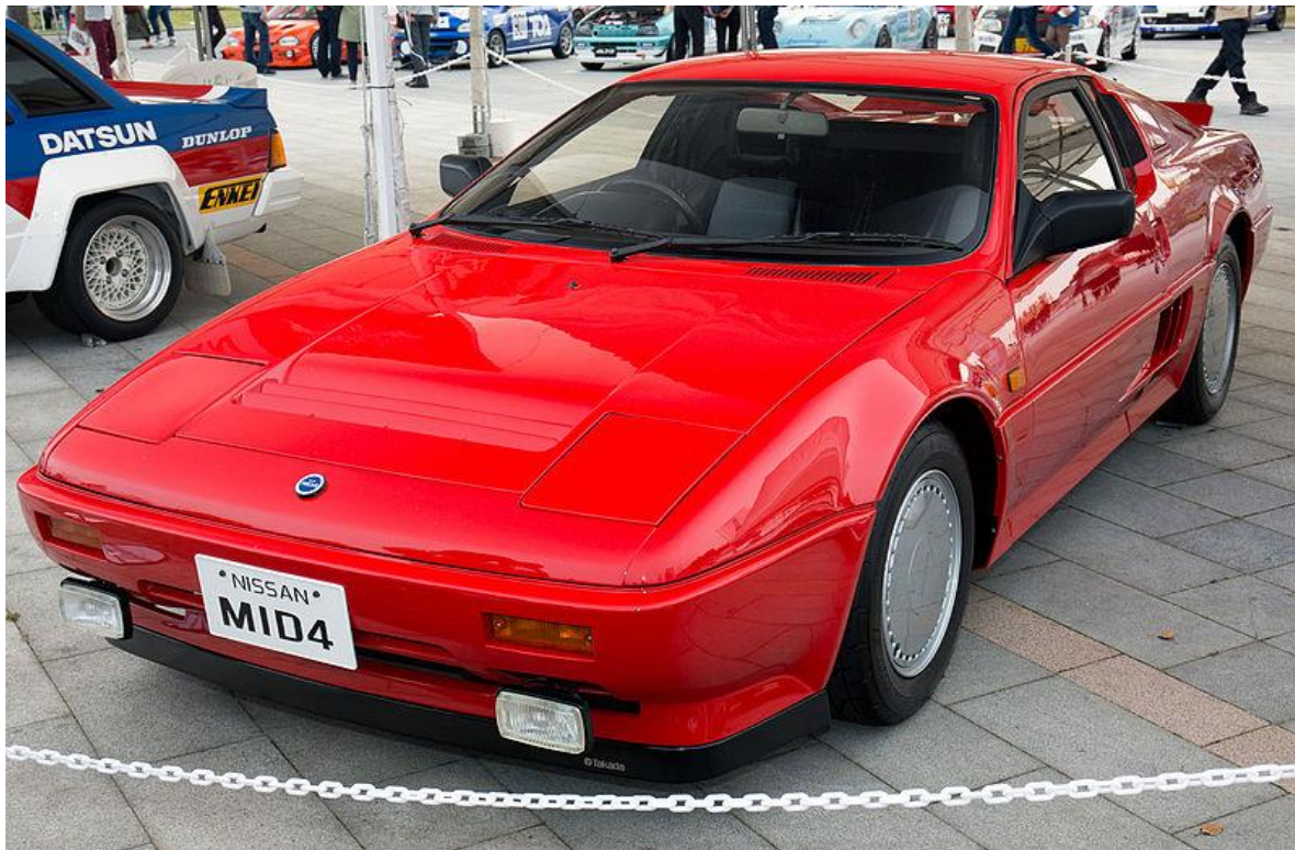
Εικόνα 1.2 β : Nissan MID 4. Μοντέλο του 1986 με μεταβλητό χρονισμό , τετρακίνητο με διανομή της ροπής 33% στον εμπρόσθιο άξονα και 67% στον οπίσθιο τύπου ATTESA (Advanced Total Traction Engineering System For All – Terrain) και τετραδιεύθυνση. (Πηγή: https://en.wikipedia.org/wiki/Nissan_MID4 ).
