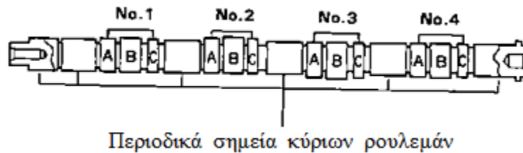
Εικόνα 7.4.3 α : Εκκεντροφόρος άξονας (Πηγή: http://www.carenthusiast.com/crxuk/VTEC_Supplement.pdf ).
