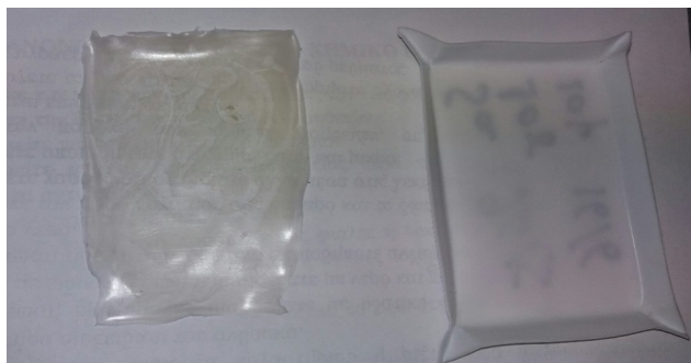
Σχήμα 12: Φόρμα χύτευσης Teflon (δεξιά), θερμοπλαστικό νανοσύνθετο φιλμ (αριστερά) (Καπίδης & Καρατζίος, 2017)
