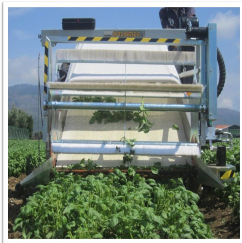
ΕΙΚΟΝΑ 6. Αυτοκινούμενη συλλεκτική μηχανή με ερπύστριες για τη συγκομιδή αρωματικών φυτών.
