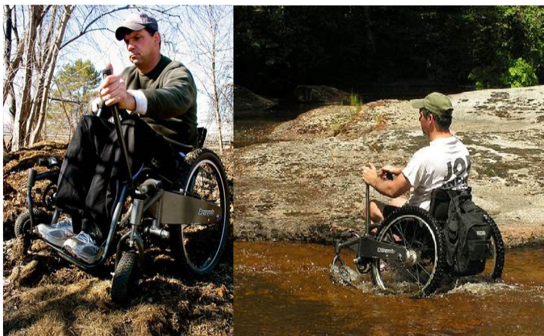
Εικόνα 4.1. Αναπηρικό αμαξίδιο με χειροκίνητο σύστημα κίνησης (Stuthridge & Field, 2012)
