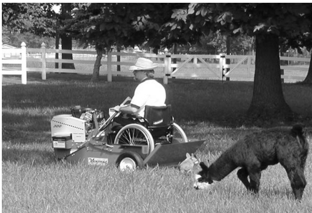
Εικόνα 3.1. Βοήθεια κινητικότητας με κινητήρα Ventrac για χρήστες αναπηρικών αμαξιδίων που επιθυμούν πρόσβαση σε ανώμαλο έδαφος. (Field & Jones as mented in Lessenger, 2006)
