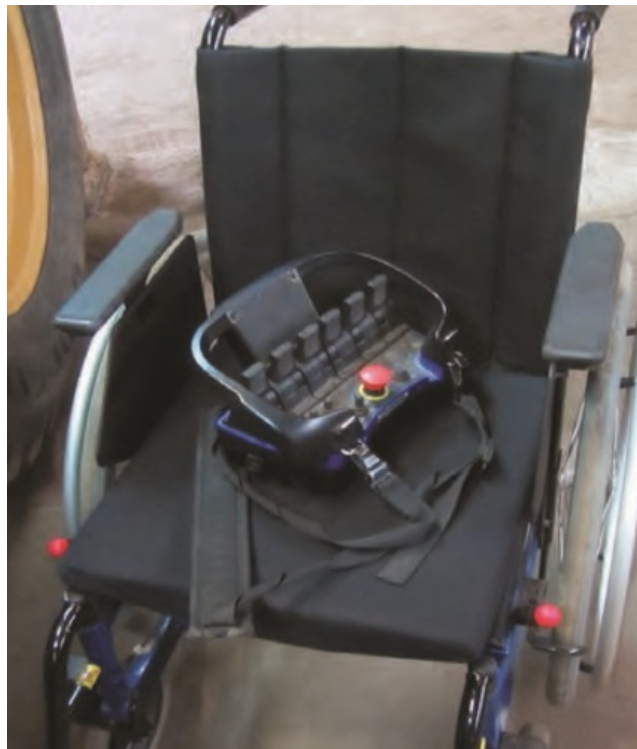
Εικόνα 5.5. Ασύρματος τύπος τηλεχειριστηρίου (Ehlers, Stuthridge, Field & Geng, 2017)
