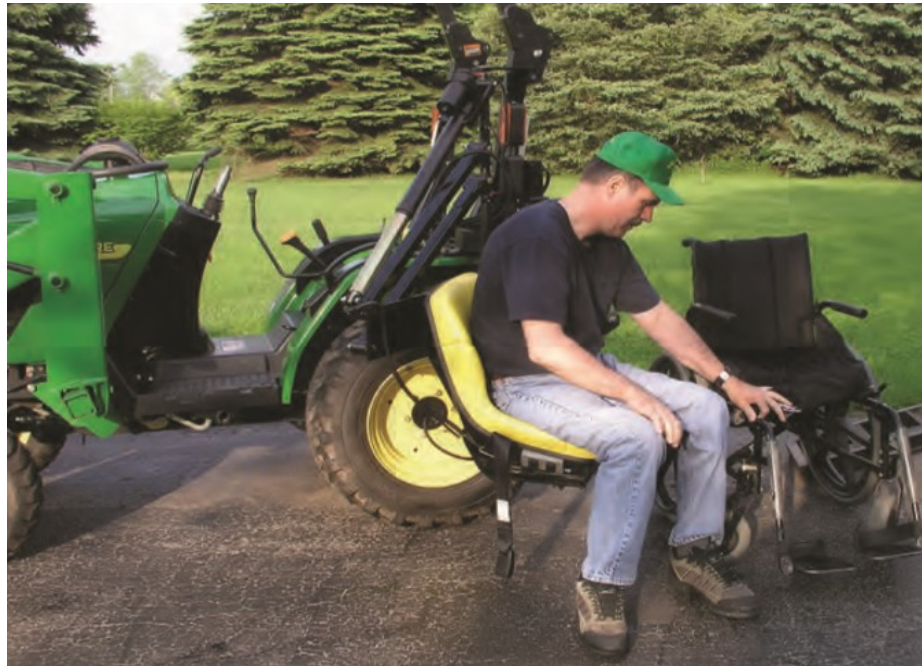
Εικόνα 3.3. Μεταφορά χρήστη σε ελκυστήρα (Ehlers, Field, & Stoller, 2018)
