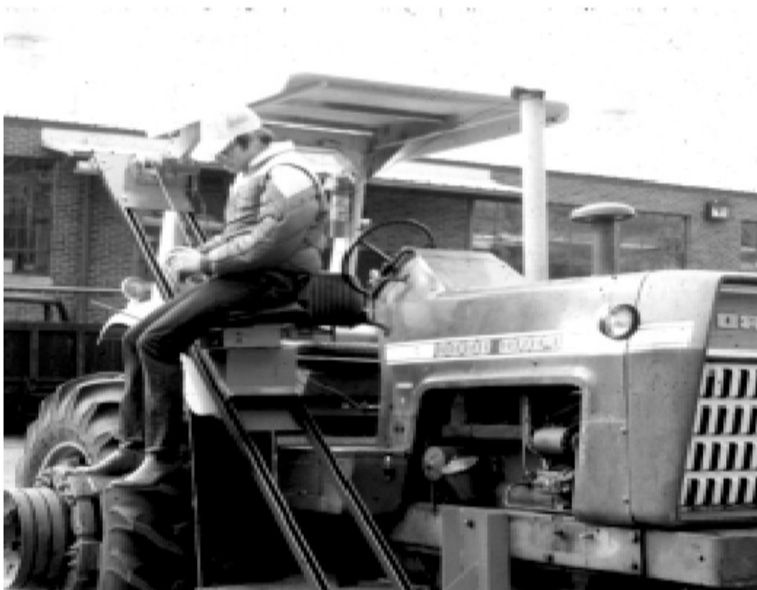
Εικόνα 3.2. Πρωτότυπος ανελκυστήρα με κάθισμα(Yoder, Stoller & Field, 2000)
