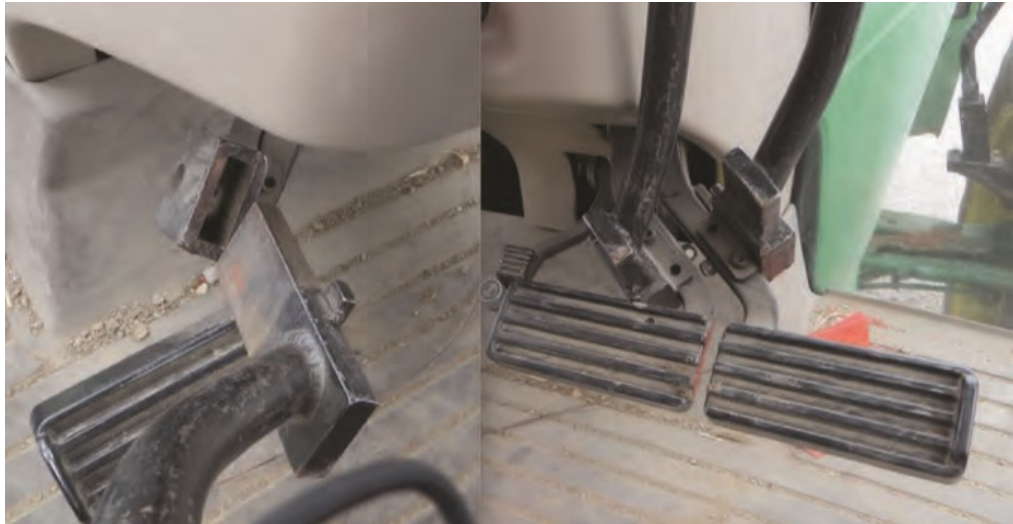
Εικόνα 5.4. Επέκταση ποδομοχλού πεδήσεως (Ehlers, Stuthridge, Field & Geng, 2017)
