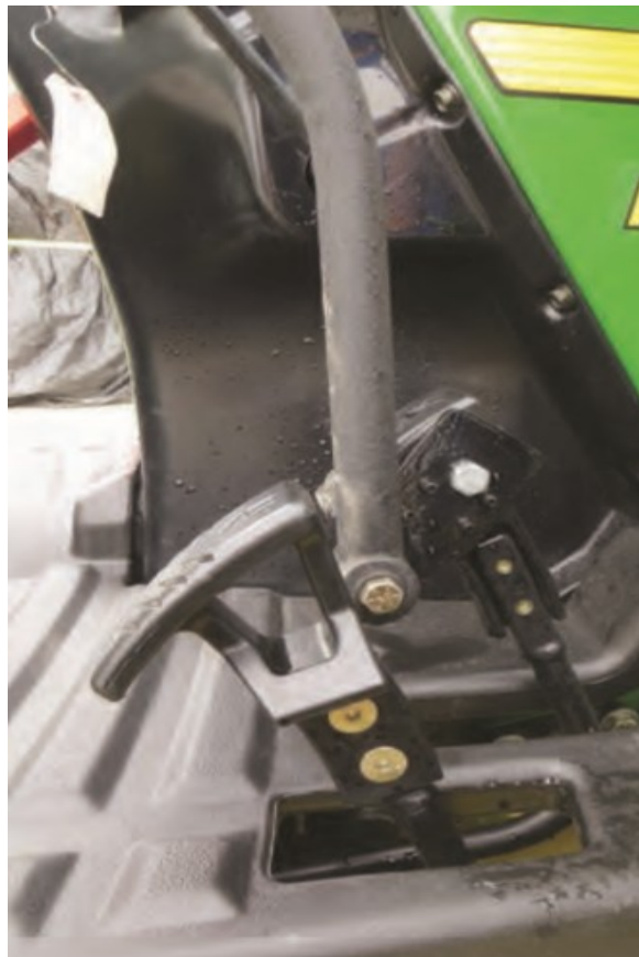
Εικόνα 5.3. Επέκταση ποδομοχλού συμπλέξεως(Ehlers, Stuthridge, Field & Geng, 2017)
