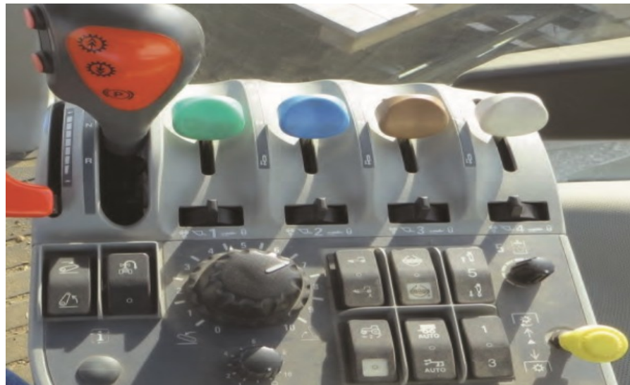
Εικόνα 5.7. Χειριστήριο οπτικής ανάγνωσης με έγχρωμη κωδικοποίηση (Ehlers, Stuthridge, Field & Geng, 2017)
