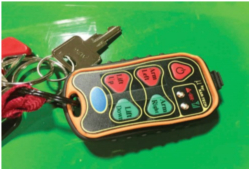
Εικόνα 5.8. Ασύρματο χειριστήριο μπρελόκ (Ehlers & Field, 2018).
