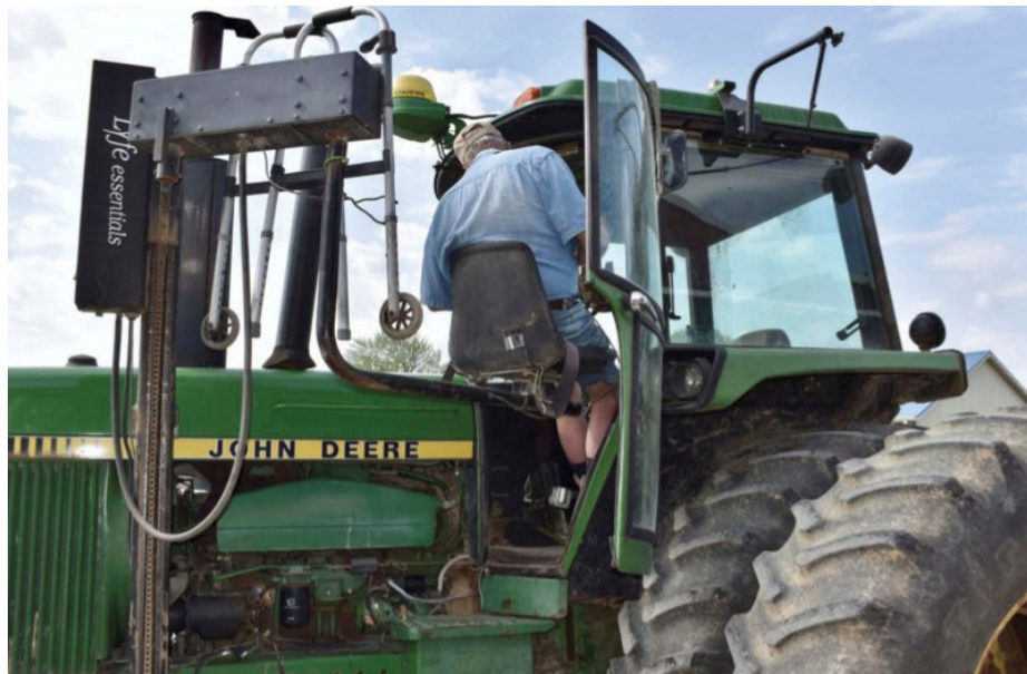
Εικόνα 3.4. Ανελκυστήρας με κάθισμα κατακόρυφης ανύψωσης (Ehlers & Field, 2018)
