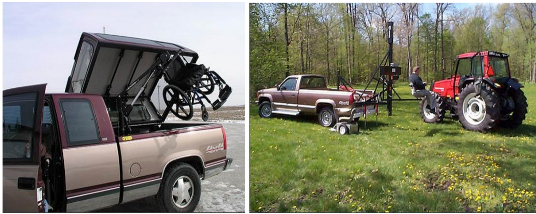
Εικόνα 4.4. Καμπίνα αποθήκευσης αμαξιδίου και σύστημα μεταφοράς σε ελκυστήρα (Stuthridge & Field, 2012)
