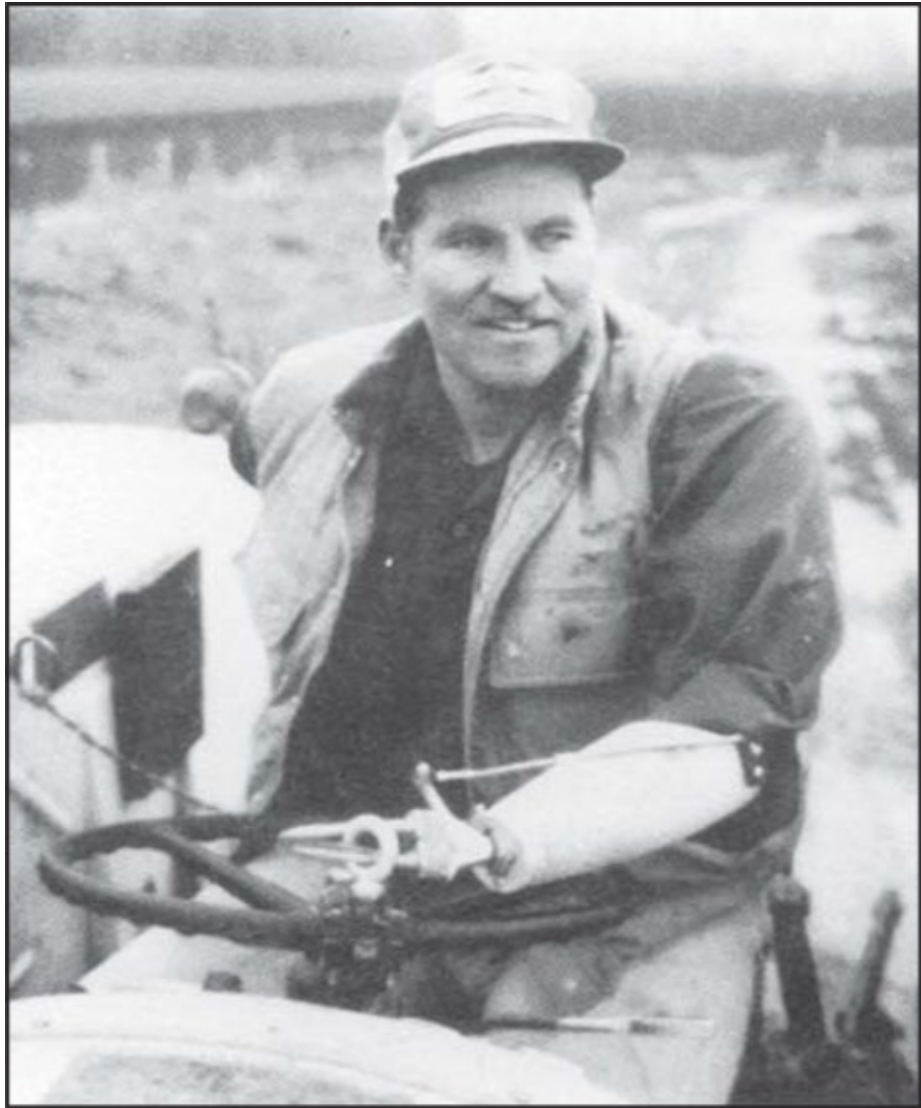
Εικόνα 5.2. Χρήση χειρολαβής σε σχήμα δακτυλίου επάνω σε τιμόνι (Willkomm & Field, 1986)
