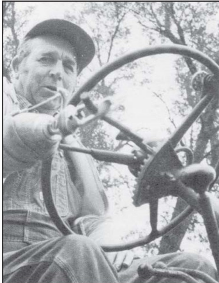
Εικόνα 5.1. Πρόσθετος μοχλός σε μοχλό επιταχύνσεως (Willkomm & Field, 1986)
