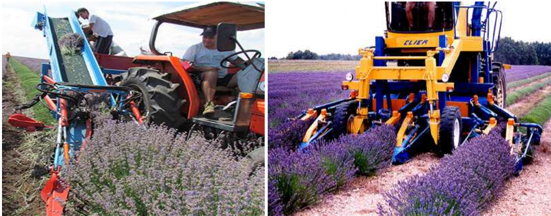
Εικόνα 1. Παρελκόμενη και αυτοκινούμενη μηχανή συγκομιδής λεβάντας (Φωτο: Γ. Τσακαλίδης).
