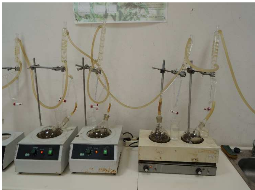
Εικόνα 7. Απόσταξη της ξηρής δρόγης σε πειραματικό αποστακτήρα Clevenger.
