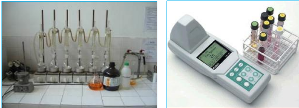
Σχήμα 3: Τυπικές διατάξεις μέτρησης του COD
