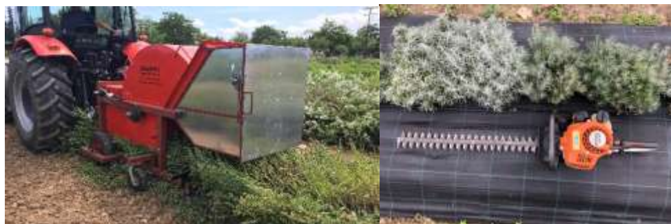
Εικ. 2.β: Μηχανή συγκομιδής με τη μέθοδο της απόσπασης και Ψαλίδι κλαδέματος χειρός και θάμνων εσωτερικής καύσης
