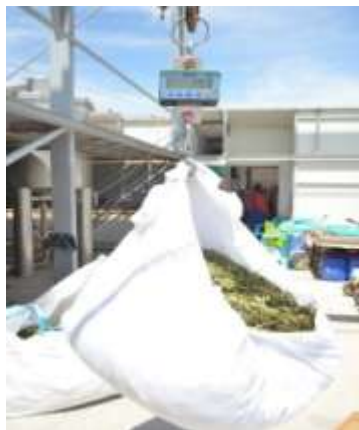
Εικ. 2.γ: Ζύγιση του υλικού πριν την απόσταξη και Τοποθέτηση υλικού στον άμβυκα προς απόσταξη.
