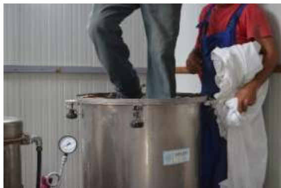
Εικ. 2.γ: Ζύγιση του υλικού πριν την απόσταξη και Τοποθέτηση υλικού στον άμβυκα προς απόσταξη.
