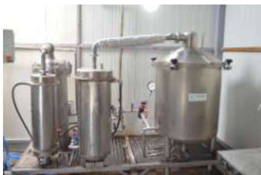
Εικ. 2.δ: Άποψη του πειραματικού αποστακτηρίου και παραλαβή αιθέριου ελαίου και ανθόνερου.
