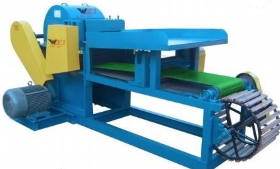
Εικόνα 12: Μηχάνημα αποχωρισμού ινών από εντεριώνη – Decorticator machine (Πηγή: http://www.weidajixie.net/20160515/8072.html )
