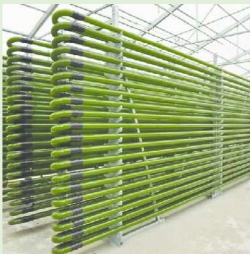
Σχήμα 1.4. Σύστημα κλειστού τύπου, φωτοβιοαντιδραστήρας (Alaswad et al., 2015)
