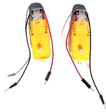
Εικόνα 1.23: Κόλληση καλωδίων στους κινητήρες
