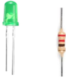
Εικόνες 1.15: LED και αντίσταση 220Ω
