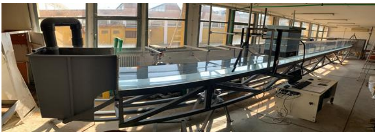
Σχήμα 3.1 Βασικό κανάλι του πειράματος.
