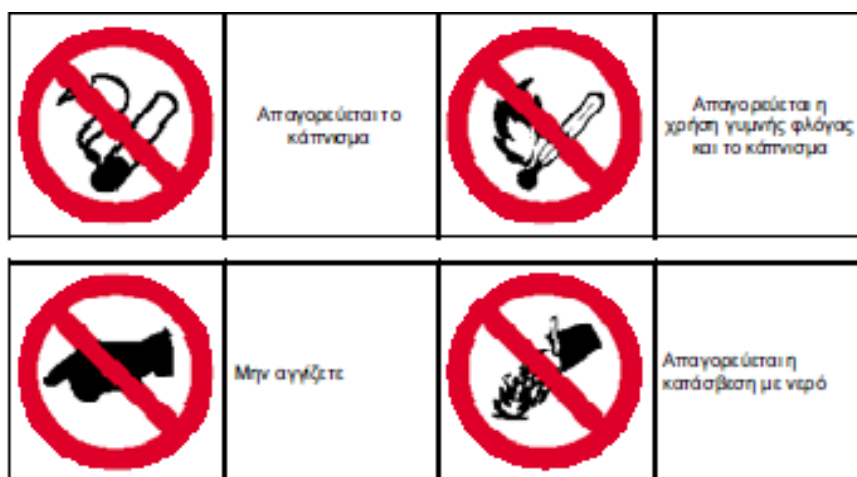
Εικόνα 1: Σήματα απαγόρευσης στο εργοτάξιο
