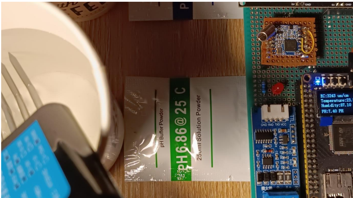
Σχήμα 4.10 Πείραμα μέτρησης pH σε γνωστό υδατικό διάλυμα με τιμή pH 6.86
