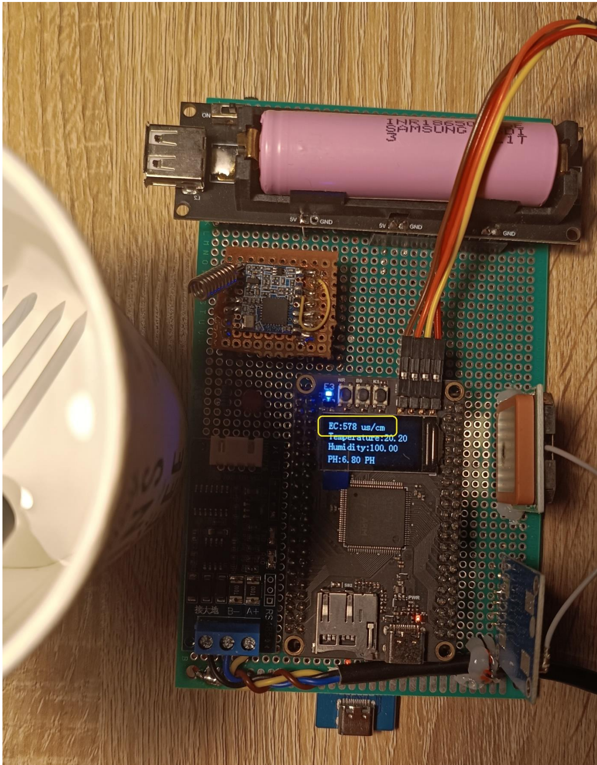
Σχήμα 4.13 Πείραμα μέτρησης αγωγιμότητας σε γνωστό υδατικό διάλυμα με τιμή 557 \mu\text{S}/\text{cm}
