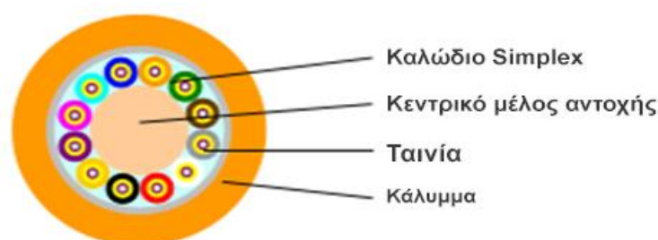
Εικόνα 4 - Καλώδια πολλαπλών ινών με πολλά ζεύγη ινών που περιβάλλουν ένα κεντρικό μέλος αντοχής
