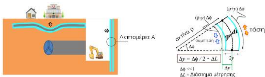
Εικόνα 32 - Μετρήσεις μετατόπισης (θήκη χωρίς αξονική δύναμη).
