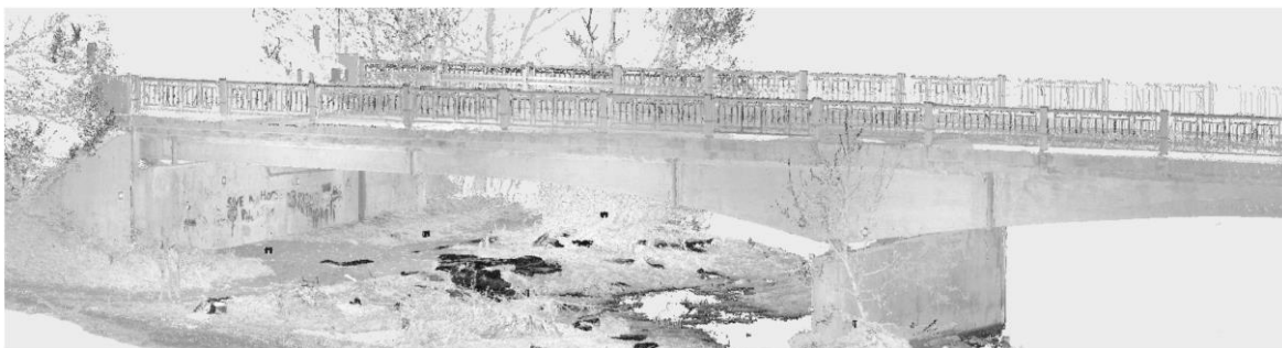
Εικόνα 15: Απεικόνιση των αποτελεσμάτων της σάρωσης της γέφυρας Conestogo με την χρήση του λέιζερ Faro Focus M, Charron et al. (2019)
