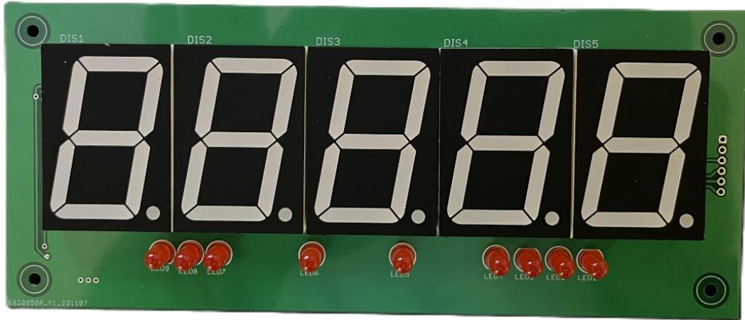
Εικόνα 5.1: Μπροστινή όψη πλακέτας οθόνης
