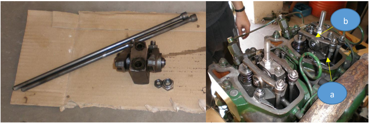
Εικόνα 3.2. Παρουσίαση ωστικής ράβδου (αριστερά) και μηχανισμού ωστικής ράβδου (a) – ζυγώθρου (b) τοποθετημένα στον κινητήρα PJ2W. [7, 12]
