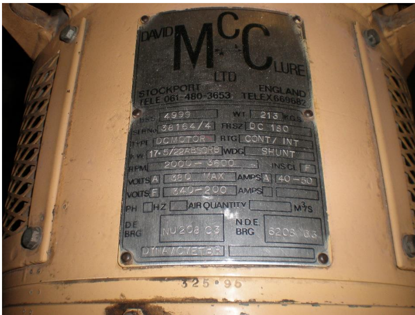
Εικόνα 4.3. Κοντινή όψη δυναμομέτρου. Στην εικόνα φαίνεται το ταμπελάκι τεχνικών χαρακτηριστικών της γεννήτριας.
