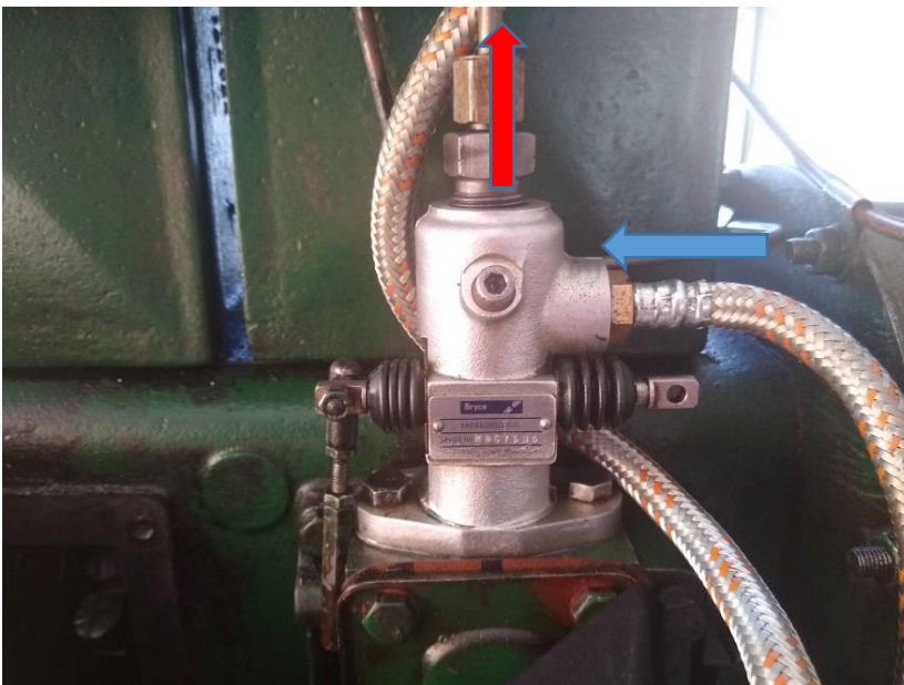
Εικόνα 5.5. Αντλία υψηλής πίεσης κινητήρα P12W. Στην εικόνα παρουσιάζεται η είσοδος και η έξοδος της αντλίας, χαμηλής και υψηλής πίεσης αντίστοιχα.
