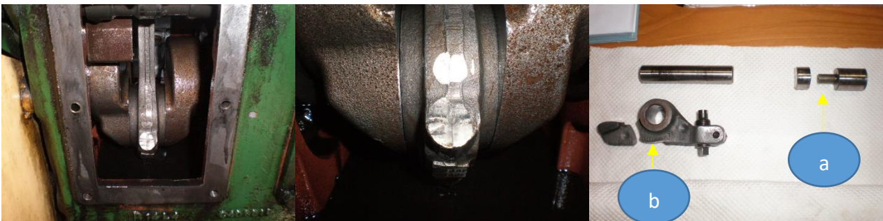
Εικόνα 5.6. Συγκεντρωτική παρουσίαση της βλάβης που προκλήθηκε από την θραύση του εμβόλου (a) που οδήγησε στο «σπάσιμο» του ζυγώθρου (b).
