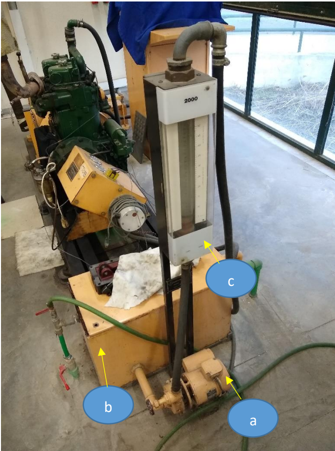
Εικόνα 4.4. Παρουσίαση συστήματος ψύξης TE95/6565. Στην εικόνα παρουσιάζονται τα εξής: a) αντλία, b) δεξαμενή ανάμιξης νερού και c) ροόμετρο.
