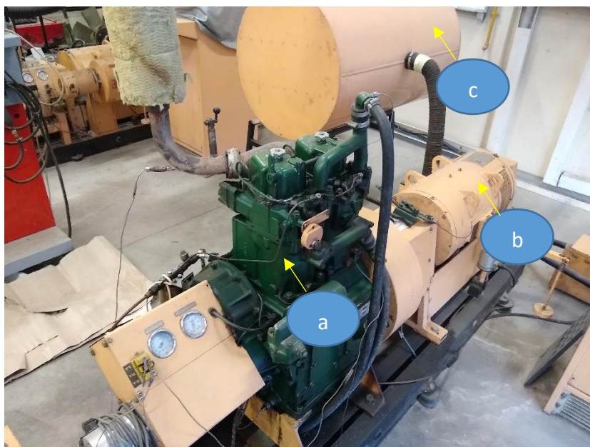
Εικόνα 4.5. Πλαϊνή όψη πειραματικής διάταξης. Στην εικόνα φαίνονται ο κινητήρας (a), το δυναμόμετρο (b) και ο αεροθάλαμος (c).
