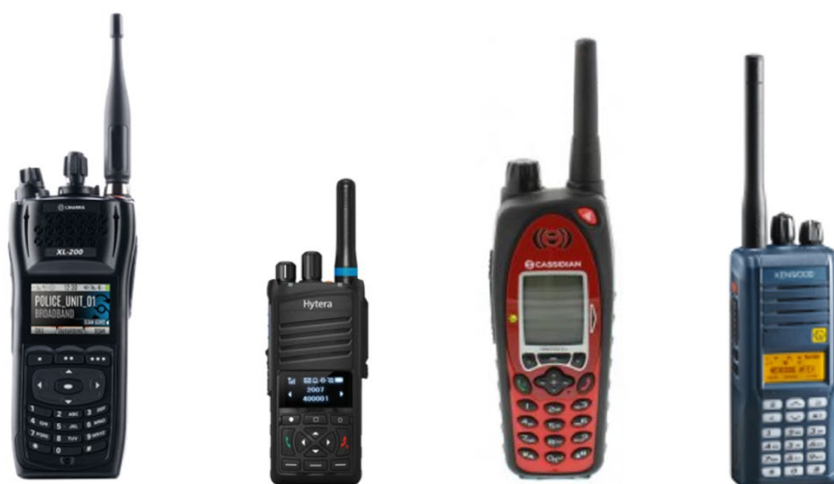
Εικόνα 142. Διάφοροι τύποι ραδιοπομποδεκτών (α)P25 radio της L3HARRIS 41 , (β)TETRA radio της Hytera 42 , (γ)TETRAPOL radio της Airbus 43 και (δ)NXDN radio/analog της KENWOOD 44
