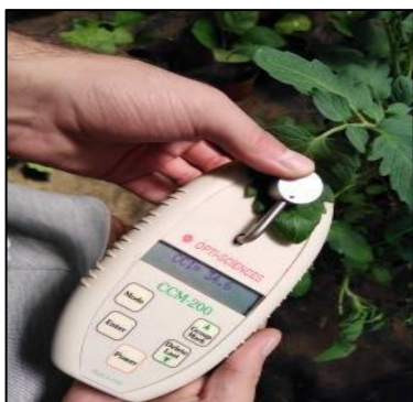
Εικ 3. Μέτρηση της χλωροφύλλης από 3 διαφορετικά φύλλα του φυτού. Πηγή: Στόικου Νικολέττα-θερμοκήπιο ΔΠΠΑΕ.
