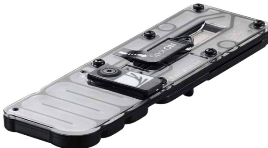
Εικόνα 5: Η συσκευή MinION, η πρώτη εμπορικά διαθέσιμη συσκευή για Nanopore sequencing ( https://store.nanoporetech.com/eu/flow-cells.html )
