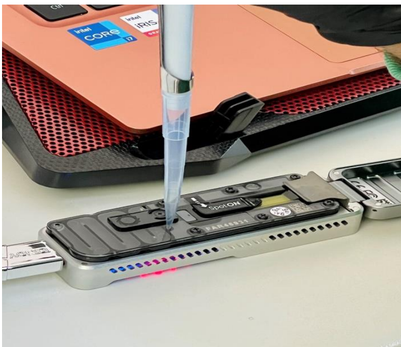
Εικόνα 14: Η έγχυση του μείγματος στην ειδική υποδοχή της κυψέλης ροής (flow cell)
