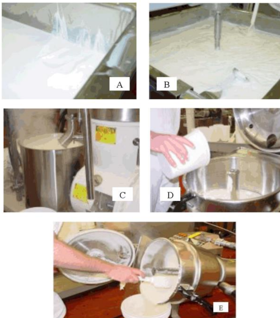
Σχήμα 3. Στάδια παρασκευής τυριού αλοιφώδους υφής. Α) Γέλη οξινισμένου γάλακτος σε pH 4,7-4,8. Β) Προετοιμασία με ανάδευση και θέρμανση για το βήμα διαχωρισμού ορού γάλακτος. Γ) Διαχωρισμός ορού γάλακτος με φυγοκεντρικό διαχωριστή. Δ) Ανάμιξη με αλάτι, σταθεροποίηση και κοπή. Ε) Τυρί κρέμα σε συσκευασία.
