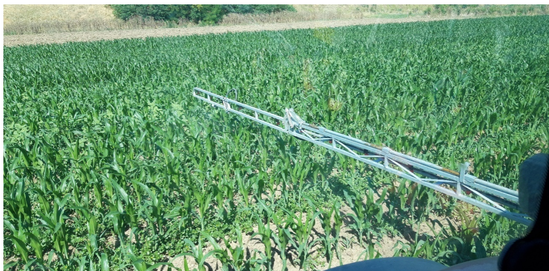
Εικόνα 2.34: Εφαρμογή των ζιζανιοκτόνων με ψεκαστικό μηχανήμα μεταβλητής δόσης (Γκατζώλης Ιωάννης).
