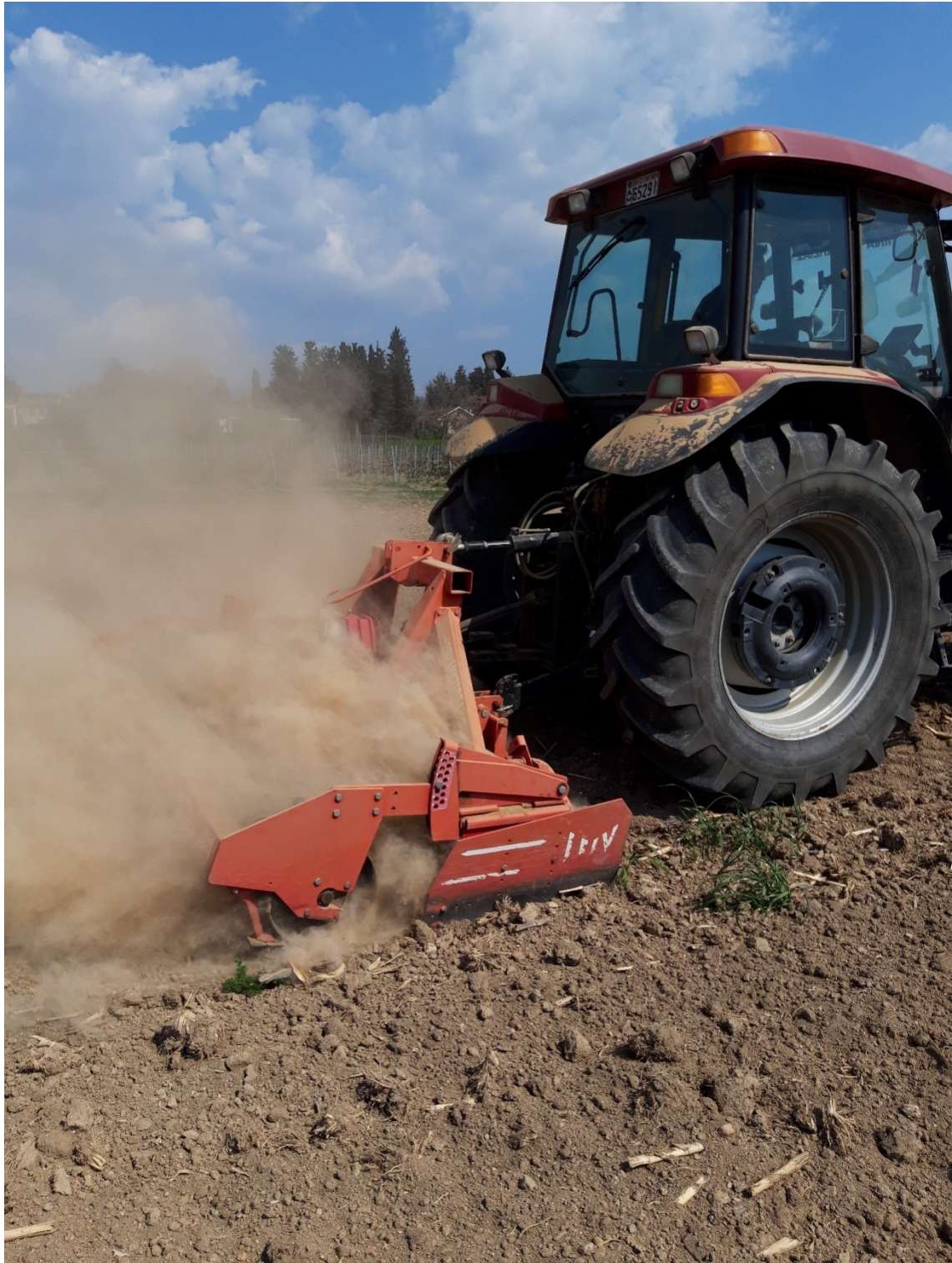
Εικόνα 2.11: Σβολοκόπτης για ψιλοτεμαχισμό του εδάφους (Γκατζώλης Ιωάννης).
