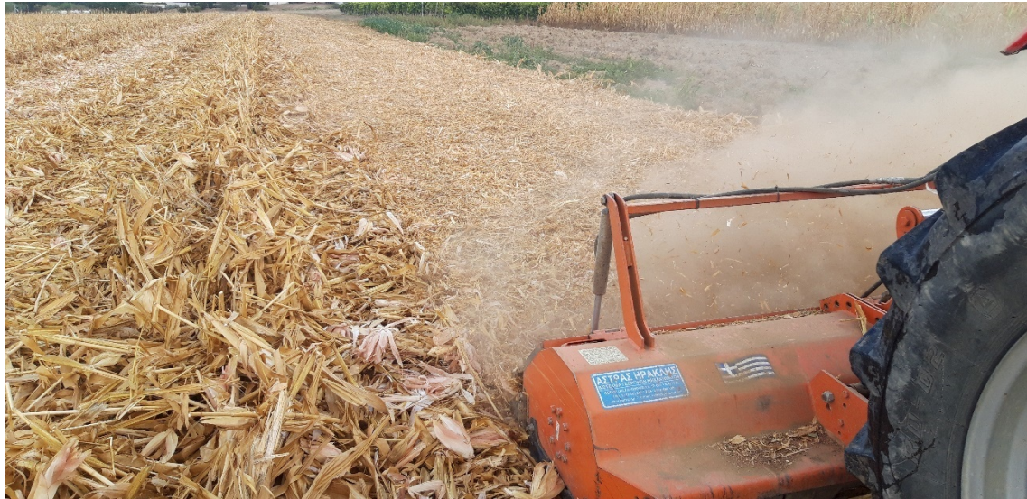
Εικόνα 2.19: Στελεχοκόπτης (καταστροφέας) ψιλοτεμαχισμός υπολείμματος καλλιέργειας (Γκατζώλης Ιωάννης).
