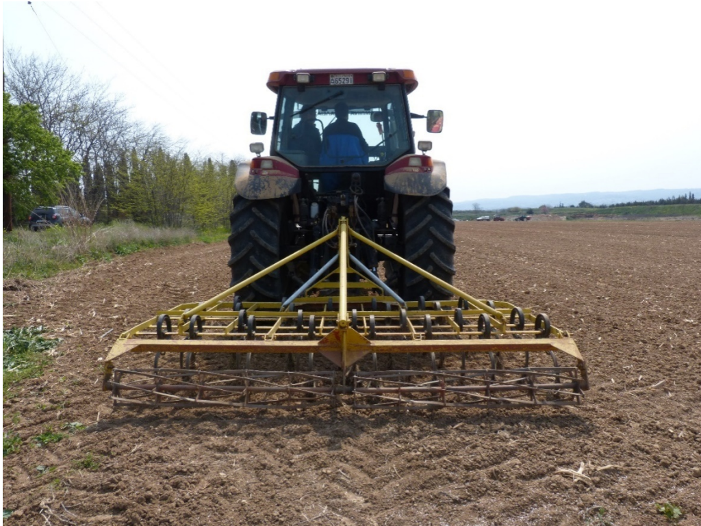
Εικόνα 2.9: Καλλιεργητής ελατηριωτός ελαφρού τύπου για την ενσωμάτωση λιπασματος και ψιλοτεμαχισμό εδάφους (Γκατζώλης Ιωάννης).
